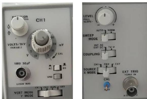
Figura 1 e 2: Controlos do CH1 e do Trigger do Osciloscópio.
