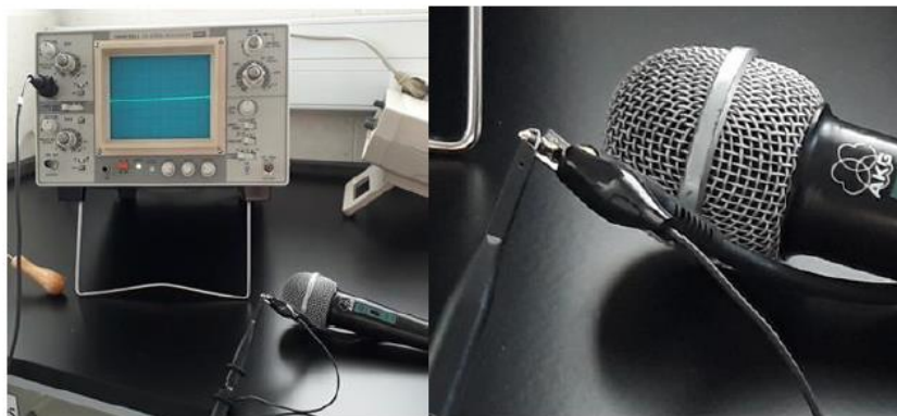
Figura 3 e 4: Ligação do Microfone ao Osciloscópio (através da ponta de prova).
