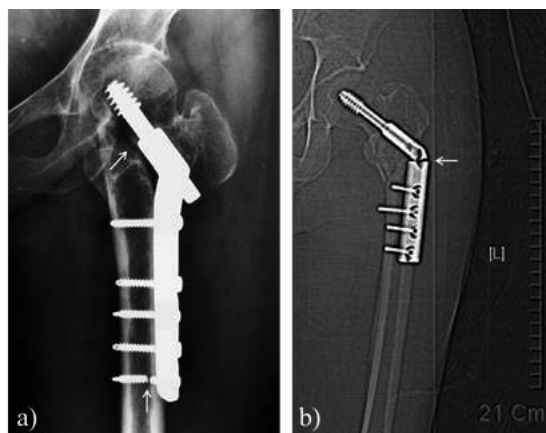
Figura 2.14 – Complicações com o dispositivo DHS: a) translação medial excessiva da diáfise, descompressão do fragmento proximal e quebra por fadiga do parafuso distal da diáfise (Retirado de: [36]); b) Ruptura da placa do sistema de fixação (Retirado de: [45]).
