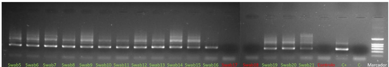
Figura 14. Eletroforese dos produtos de PCR resultantes da amplificação da região V3-V3 do 16s rRNA. O esfregaço 17 (Swab17) e o controlo do kit apresentam bandas muito tênues. O esfregaço 18 (Swab18) não possui qualquer banda.
