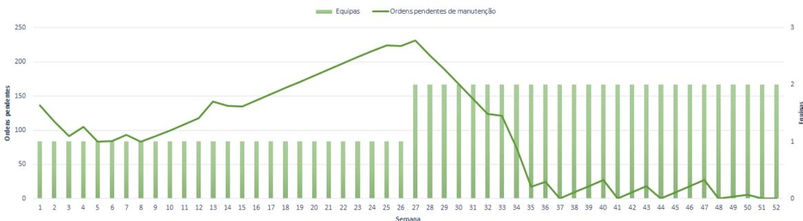
Fig. B.8 Análise do comportamento das ordens pendentes de manutenção e das equipas ao longo do período de estudo na solução do modelo M1.3 na empresa 8.
