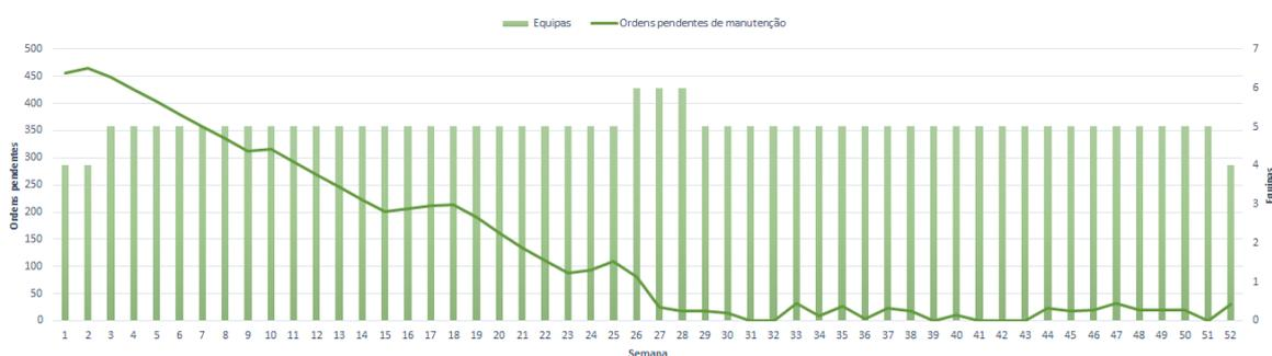
Fig. C.7 Análise do comportamento das ordens pendentes de manutenção e das equipas ao longo do período de estudo na solução do modelo M2 na empresa 7.
