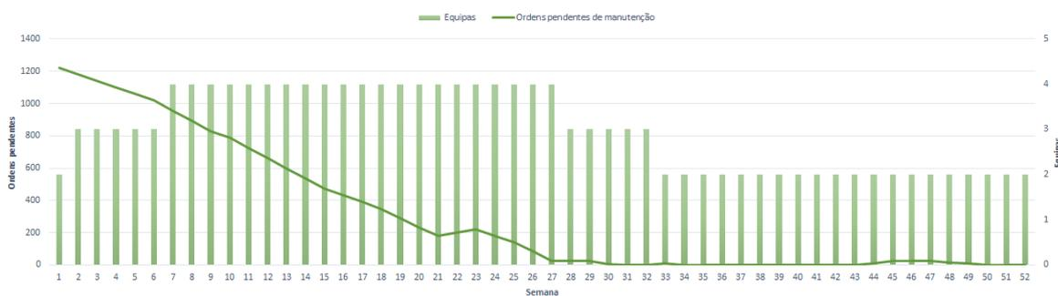
Fig. C.6 Análise do comportamento das ordens pendentes de manutenção e das equipas ao longo do período de estudo na solução do modelo M2 na empresa 6.
