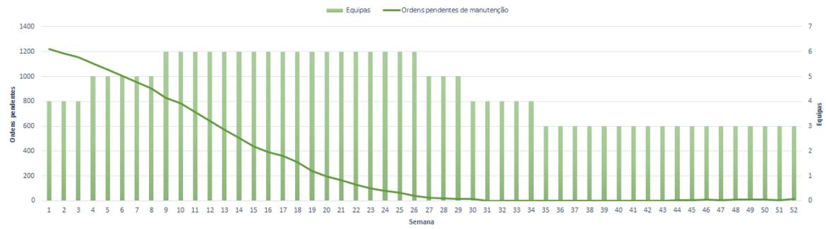
Fig. C.10 Análise do comportamento das ordens pendentes de manutenção e das equipas ao longo do período de estudo na solução do modelo M2 na empresa 10.
