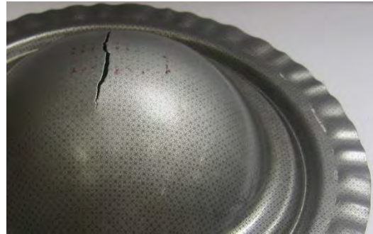
شکل (۶-۴) (الف) ورق گریدبندی شده بعد از تغییر شکل (ب) تغییر شکل یک گرید دایره‌ای به بیضی
