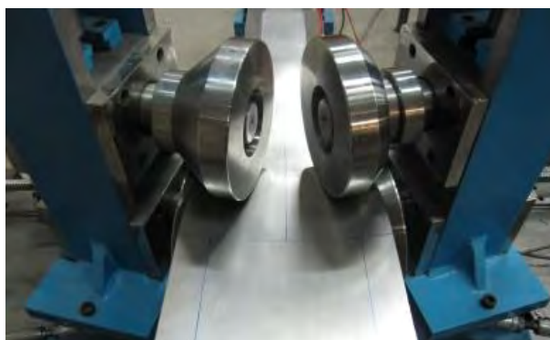
شکل (۴-۶-۱) نمایی از دستگاه شکل‌دهی غلتکی انعطاف‌پذیر تک ایستگاه به هنگام شکل‌دهی ناحیه انتقال
