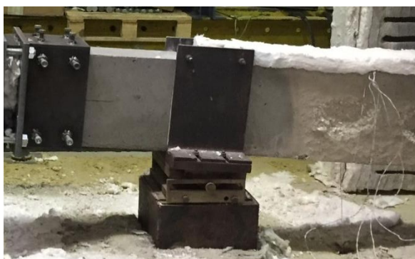
Figura F.18 – Vistas frontais da configuração deformada da viga nas regiões próximas aos apoios simples e duplo, respectivamente, após ensaio ka1_kr0_2.
