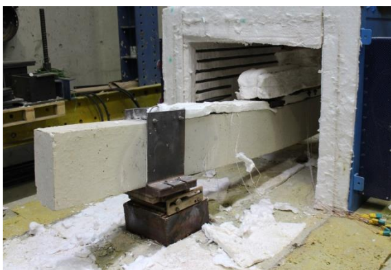
Figura F.13 – Vista lateral da configuração deformada da viga após ensaio ka0_kr0_2.
