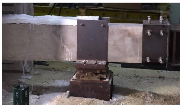
Figura F.18 – Vistas frontais da configuração deformada da viga nas regiões próximas aos apoios simples e duplo, respectivamente, após ensaio ka1_kr0_2.
