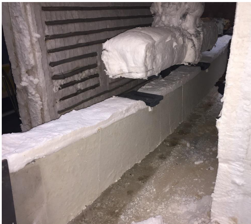
Figura 3.68 – Configuração deformada da viga com nível de restrição axial mais baixo do ensaio ka1_kr0_1.
