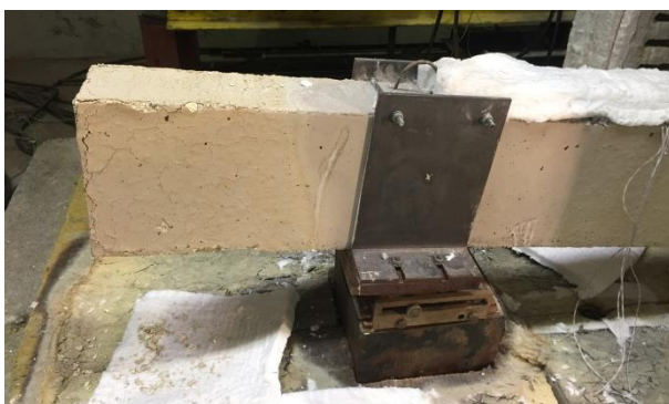
Figura F.9 – Vistas frontais da configuração deformada da viga nas regiões próximas aos apoios simples e duplo, respectivamente, após ensaio ka0_kr0_1.
