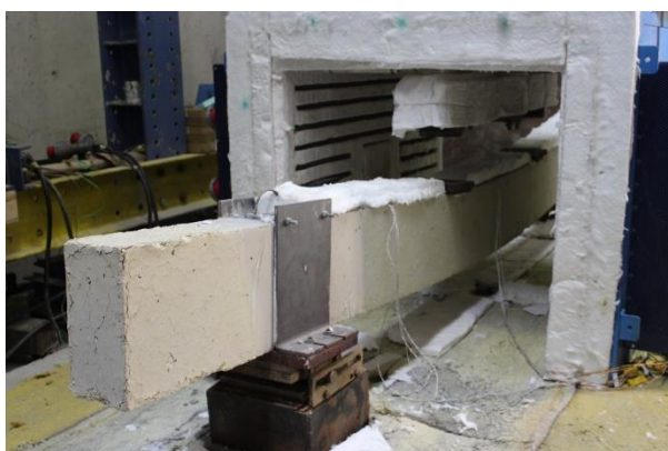
Figura F.10 – Vista lateral da configuração deformada da viga após ensaio ka0_kr0_1.
