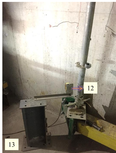
Legenda: 12. Transdutor de cabo para medição dos deslocamentos da viga de concreto; 13. Piso inferior do LEME.
