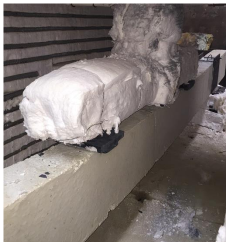
Figura F.8 – Vistas laterais da configuração deformada da viga após ensaio ka0_kr0* (sem manta).
