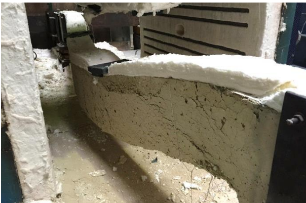
Figura F.40 – Instabilidade lateral com torção da viga após ensaio ka1_kr2_1.
