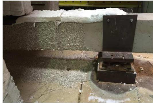
Figura F.21 – Vistas frontais da configuração deformada da viga nas regiões próximas aos apoios simples e duplo, respectivamente, após ensaio ka2_kr0_1.
