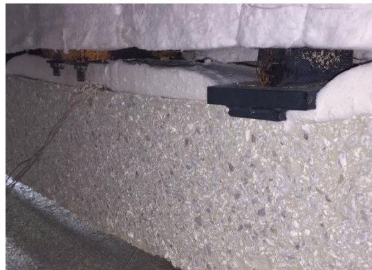
Figura F.23 – Detalhe da esfoliação do concreto da superfície, já com agregados à mostra, pelo fato de não ter sido possível abrir o forno no dia seguinte ao ensaio ka2_kr0_1.
