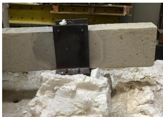
Figura F.7 – Vistas frontais da configuração deformada da viga nas regiões próximas aos apoios simples e duplo, respectivamente, após ensaio ka0_kr0* (sem manta na face superior).
