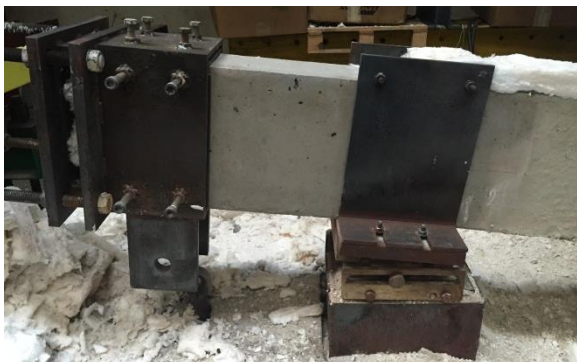
Figura F.15 – Vistas frontais da configuração deformada da viga nas regiões próximas aos apoios simples e duplo, respectivamente, após ensaio ka1_kr0_1.
