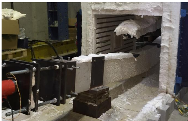
Figura F.25 – Vista lateral da configuração deformada da viga após ensaio ka2_kr0_2.
