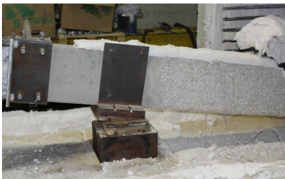
Figura F.24 – Vistas frontais da configuração deformada da viga nas regiões próximas aos apoios simples e duplo, respectivamente, após ensaio ka2_kr0_2.
