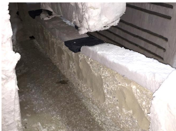
Figura F.5 – Vista lateral da configuração deformada da viga após ensaio T_ka0_kr0_2.
