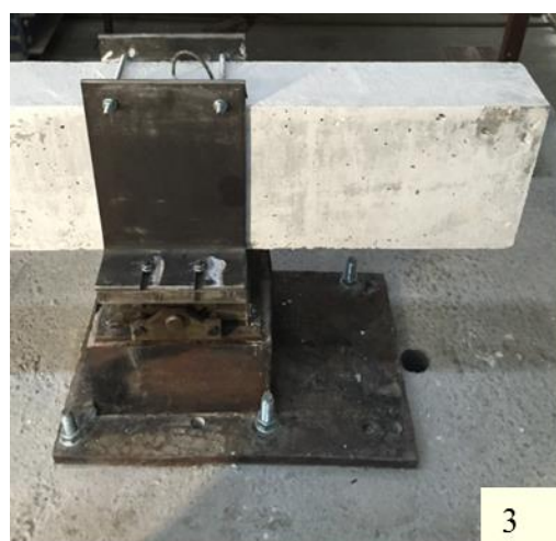
Figura 3.1 – Vista geral do sistema para ensaios de vigas simplesmente apoiadas à temperatura ambiente.
