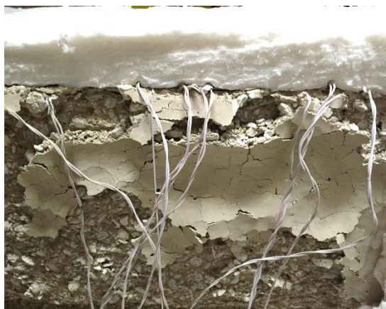
Figura F.6 – Detalhe da esfoliação do concreto da superfície, já com agregados à mostra, pelo fato de não ter sido possível abrir o forno no dia seguinte ao ensaio T_ka0_kr0_2.
