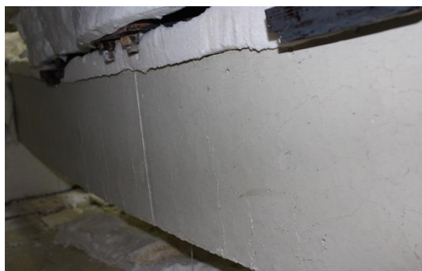
Figura F.14 – Detalhe da aparência “craquelada” da superfície de concreto e das fissuras de flexão após ensaio ka0_kr0_2.
