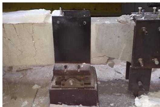
Figura F.27 – Vistas frontais da configuração deformada da viga nas regiões próximas aos apoios simples e duplo, respectivamente, após ensaio ka1_kr1_1.
