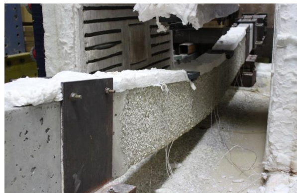
Figura F.26 – Detalhe da esfoliação do concreto da superfície, já com agregados à mostra, pelo fato de não ter sido possível abrir o forno no dia seguinte ao ensaio ka2_kr0_2.
