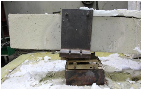
Figura F.12 – Vistas frontais da configuração deformada da viga nas regiões próximas aos apoios simples e duplo, respectivamente, após ensaio ka0_kr0_2.
