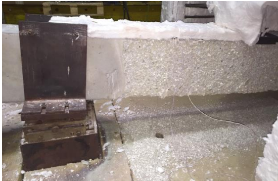
Figura F.21 – Vistas frontais da configuração deformada da viga nas regiões próximas aos apoios simples e duplo, respectivamente, após ensaio ka2_kr0_1.
