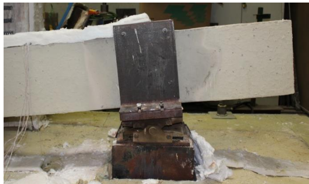
Figura F.12 – Vistas frontais da configuração deformada da viga nas regiões próximas aos apoios simples e duplo, respectivamente, após ensaio ka0_kr0_2.
