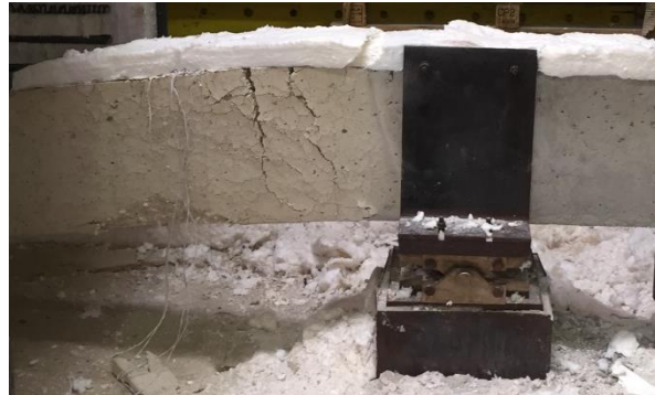
Figura F.39 – Vistas frontais da configuração deformada da viga nas regiões próximas aos apoios simples e duplo, respectivamente, após ensaio ka1_kr2_1.
