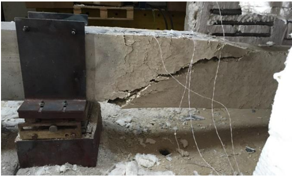
Figura F.30 – Vistas frontais da configuração deformada da viga nas regiões próximas aos apoios simples e duplo, respectivamente, após ensaio ka1_kr1_2.
