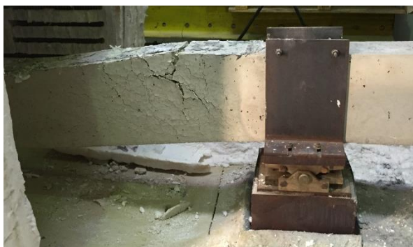
Figura F.33 – Vistas frontais da configuração deformada da viga nas regiões próximas aos apoios simples e duplo, respectivamente, após ensaio ka2_kr1_1.
