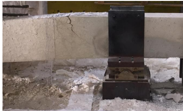
Figura F.30 – Vistas frontais da configuração deformada da viga nas regiões próximas aos apoios simples e duplo, respectivamente, após ensaio ka1_kr1_2.
