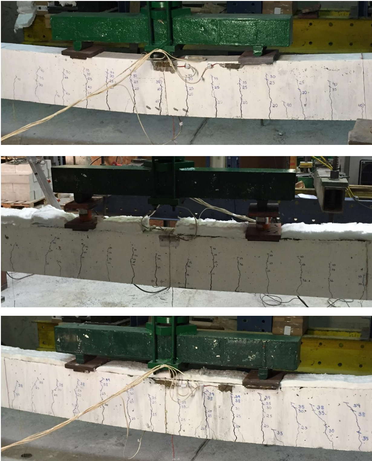
Figura 3.47 – Campos de fissuras registrados pouco antes da finalização dos ensaios de vigas simplesmente apoiadas à temperatura ambiente A_ka0_kr0_1, A_ka0_kr0_2 e A_ka0_kr0_3, respectivamente.
