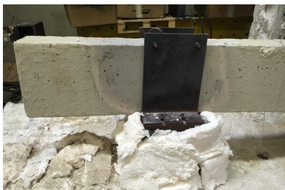
Figura F.7 – Vistas frontais da configuração deformada da viga nas regiões próximas aos apoios simples e duplo, respectivamente, após ensaio ka0_kr0* (sem manta na face superior).
