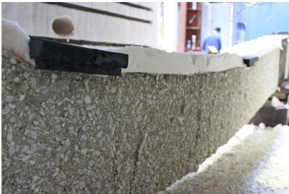
Figura 3.70 – Configuração deformada da viga com nível de restrição axial mais alto do ensaio ka2_kr0_2, com esfoliação do concreto presente nas superfícies.
