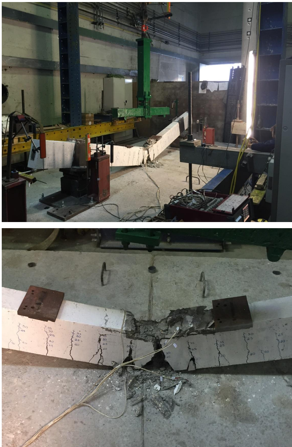
Figura 3.48 – Aspecto final da viga de concreto armado do ensaio A_ka0_kr0_1, com modo de ruptura à flexão.
