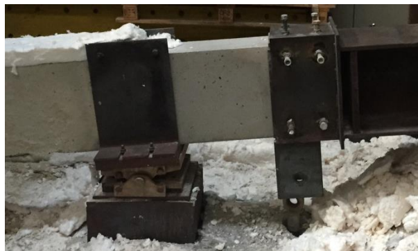
Figura F.15 – Vistas frontais da configuração deformada da viga nas regiões próximas aos apoios simples e duplo, respectivamente, após ensaio ka1_kr0_1.
