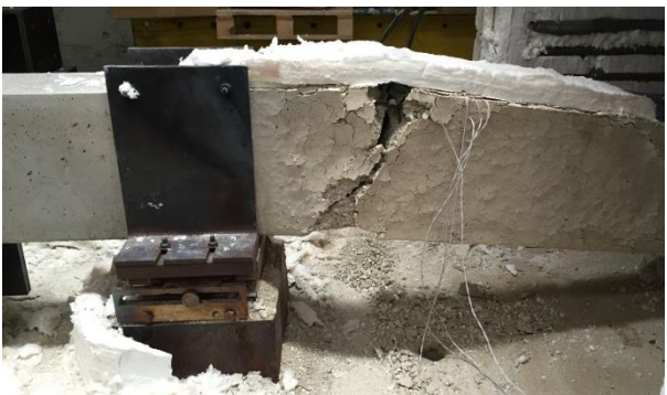
Figura F.42 – Vistas frontais da configuração deformada da viga nas regiões próximas aos apoios simples e duplo, respectivamente, após ensaio ka1_kr2_2.
