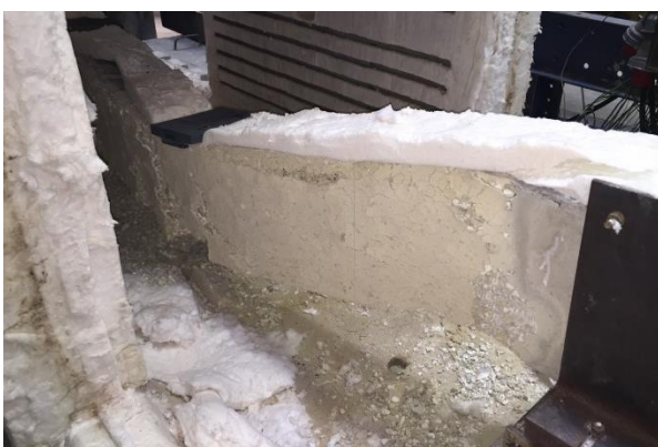
Figura F.37 – Instabilidade lateral com torção da viga após ensaio ka2_kr1_2.
