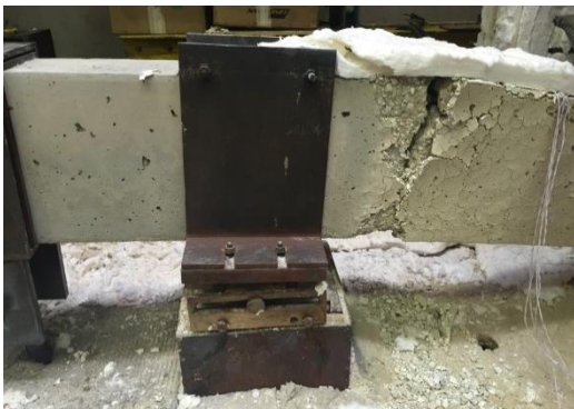
Figura F.36 – Vistas frontais da configuração deformada da viga nas regiões próximas aos apoios simples e duplo, respectivamente, após ensaio ka2_kr1_2.
