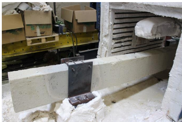
Figura F.8 – Vistas laterais da configuração deformada da viga após ensaio ka0_kr0* (sem manta).
