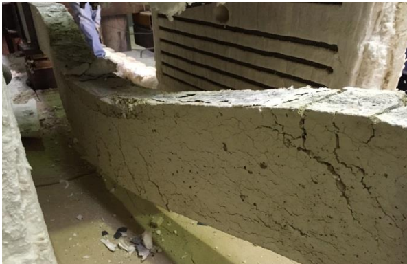
Figura F.34 – Instabilidade lateral com torção da viga após ensaio ka2_kr1_1.
