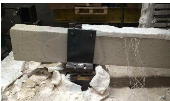
Figura F.1 – Vistas frontais da configuração deformada da viga nas regiões próximas aos apoios simples e duplo, respectivamente, após ensaio T_ka0_kr0_1.
