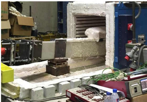
Figura F.22 – Vista lateral da configuração deformada da viga após ensaio ka2_kr0_1.
