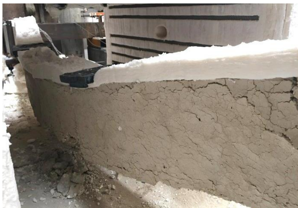
Figura F.43 – Instabilidade lateral com torção da viga após ensaio ka1_kr2_2.
