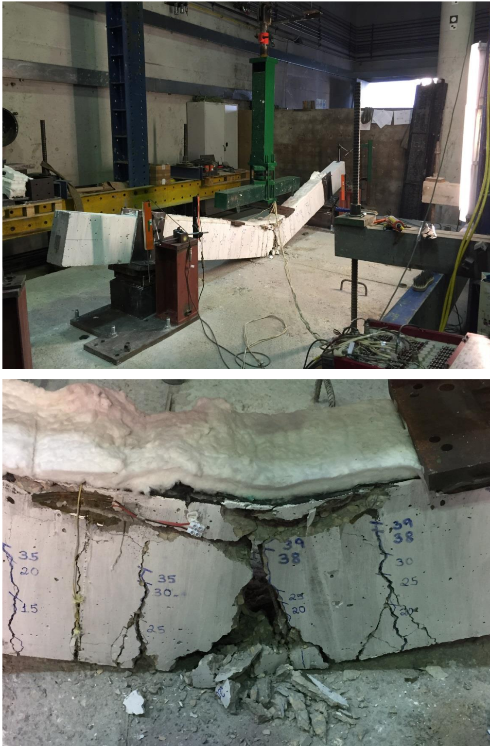
Figura 3.49 – Aspecto final da viga de concreto armado do ensaio A_ka0_kr0_3, com modo de ruptura à flexão.
