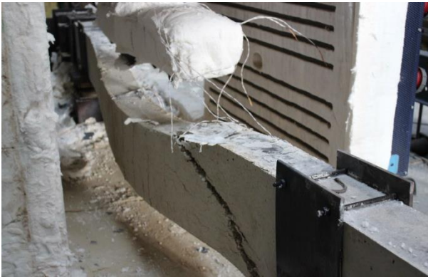
Figura F.31 – Instabilidade lateral com torção da viga após ensaio ka1_kr1_2.
