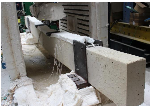
Figura F.2 – Vista lateral da configuração deformada da viga após ensaio T_ka0_kr0_1.
