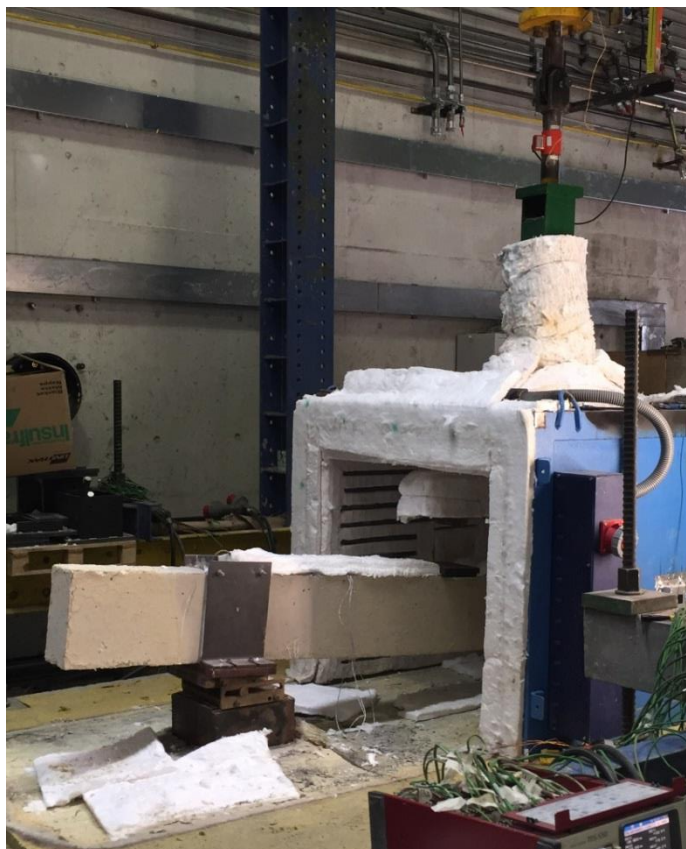
Figura 3.65 – Vista geral da configuração deformada da viga simplesmente apoiada do ensaio ka0_kr0_1.
