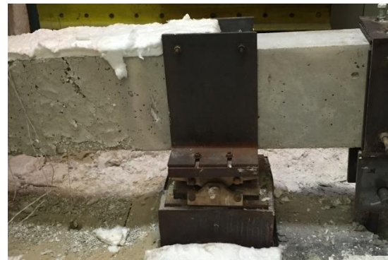
Figura F.36 – Vistas frontais da configuração deformada da viga nas regiões próximas aos apoios simples e duplo, respectivamente, após ensaio ka2_kr1_2.
