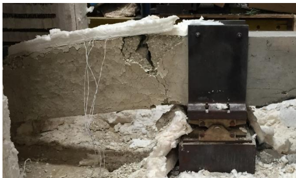
Figura F.42 – Vistas frontais da configuração deformada da viga nas regiões próximas aos apoios simples e duplo, respectivamente, após ensaio ka1_kr2_2.
