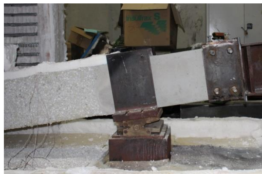
Figura F.24 – Vistas frontais da configuração deformada da viga nas regiões próximas aos apoios simples e duplo, respectivamente, após ensaio ka2_kr0_2.
