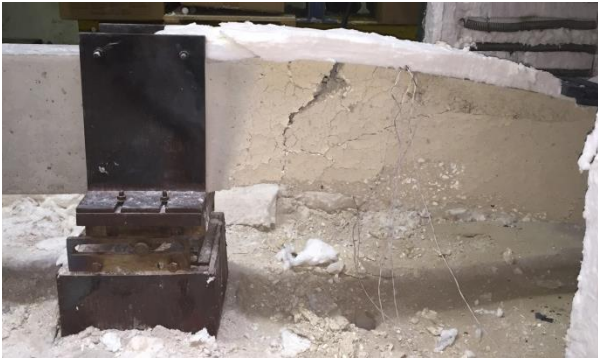
Figura F.39 – Vistas frontais da configuração deformada da viga nas regiões próximas aos apoios simples e duplo, respectivamente, após ensaio ka1_kr2_1.
