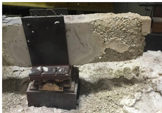
Figura F.4 – Vistas frontais da configuração deformada da viga nas regiões próximas aos apoios simples e duplo, respectivamente, após ensaio T_ka0_kr0_2.
