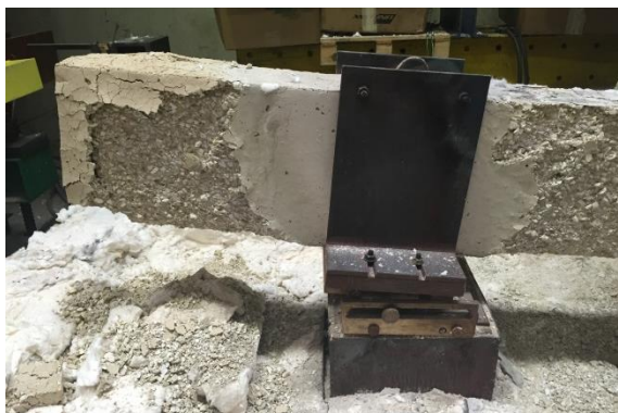
Figura F.4 – Vistas frontais da configuração deformada da viga nas regiões próximas aos apoios simples e duplo, respectivamente, após ensaio T_ka0_kr0_2.
