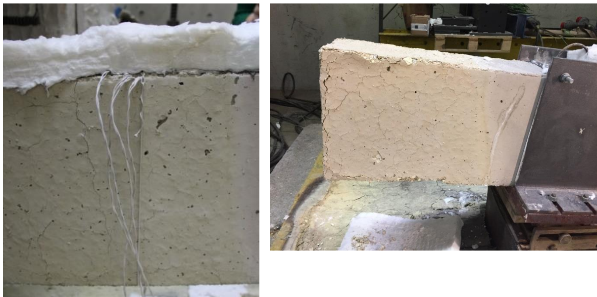
Figura 3.66 – Aparência “craquelada” das superfícies de concreto da viga simplesmente apoiada ka0_kr0_1.
