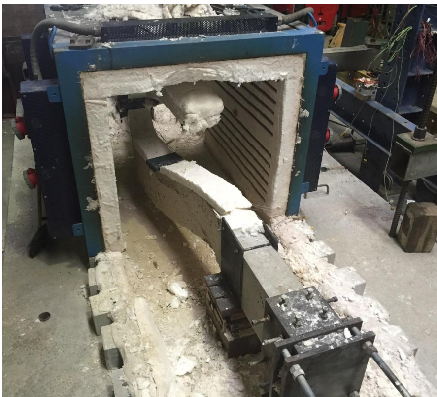
Figura 3.71 – Instabilidade lateral com torção da viga com restrições axial e rotacional do ensaio ka1_kr2_1.
