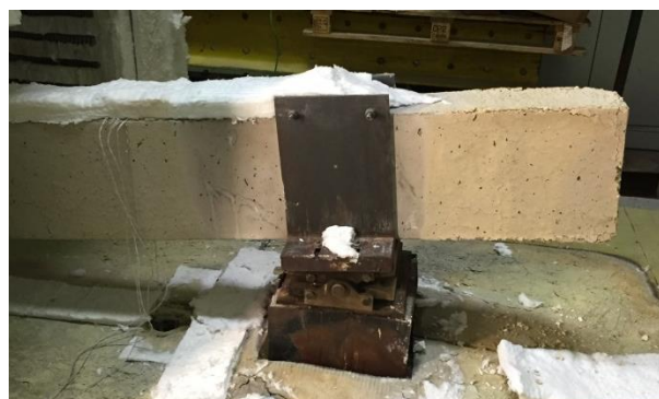
Figura F.9 – Vistas frontais da configuração deformada da viga nas regiões próximas aos apoios simples e duplo, respectivamente, após ensaio ka0_kr0_1.
