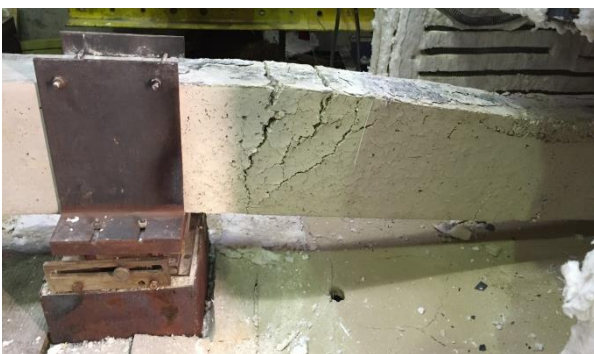
Figura F.33 – Vistas frontais da configuração deformada da viga nas regiões próximas aos apoios simples e duplo, respectivamente, após ensaio ka2_kr1_1.
