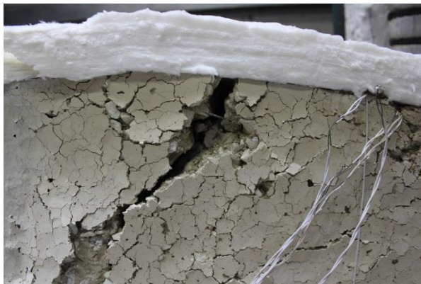
Figura F.41 – Detalhe da região próxima a um dos apoios onde se verificou a ruptura da armadura longitudinal superior, após ensaio ka1_kr2_1.
