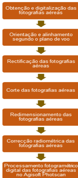
Figura 16 – Fluxograma da metodologia utilizada para o processamento fotogramétrico de fotografias aéreas.
