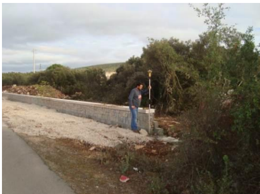
Figura 41 – Levantamento com o GPS – Topocom Gr3.
