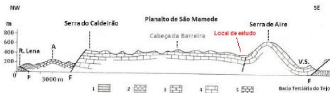
Figura 6 – Corte esquemático da região setentrional do Maciço Calcário Estremenho adaptado de MARTINS (1949). Legenda: 1– Margas hetangianas; 2 – Calcários do Dogger; 3 – Calcários do Lusitaniano; 4 – Camadas calco-argilosas do Kimeridgiano; 5 – Formações da Bacia Terciária do Tejo. Abreviaturas: A – Anticlinal de Alqueidão; V.S – Vale da Serra. Escala horizontal: 1:100 000. Exagero
