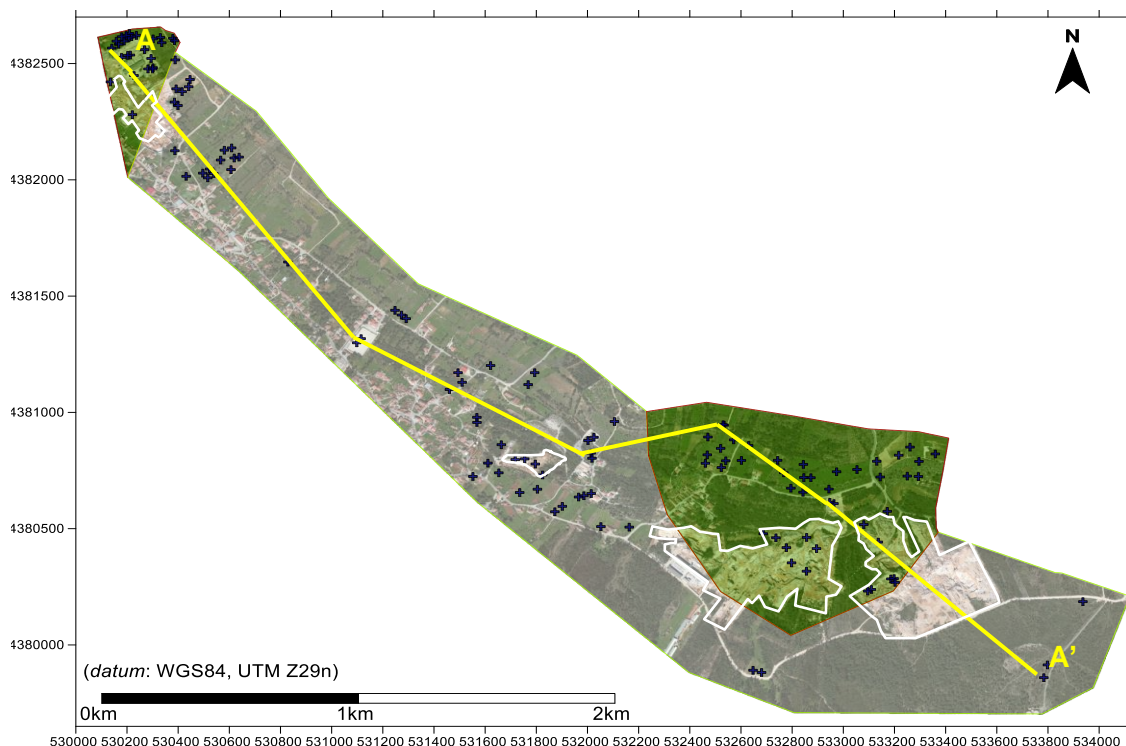
Figura 203 – Localização das sondagens TDEM no extrato do Google Earth Pro (2015). com indicação das áreas de estudo. Polígonos brancos - Delimitação das áreas extrativas. Linha amarela - Localização o Perfil A-A'.
