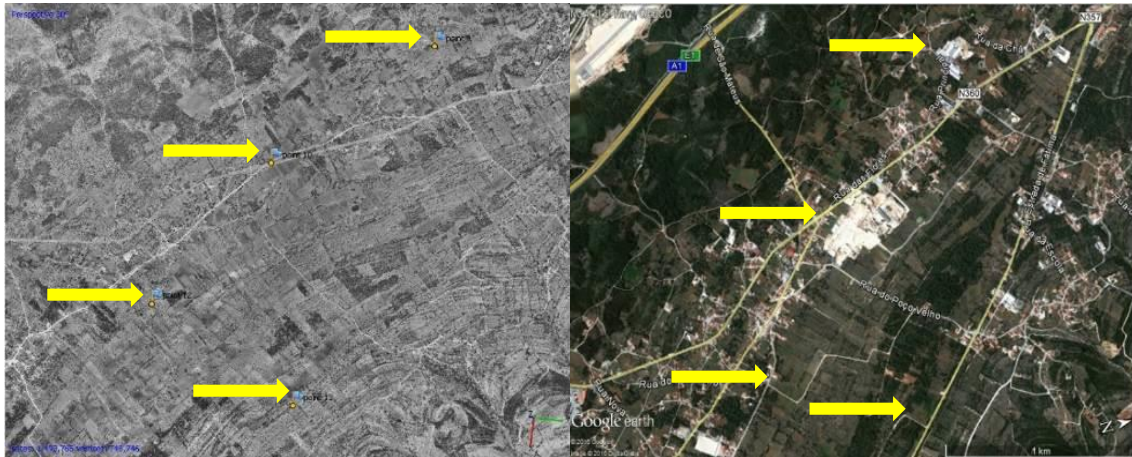
Figura 22 – a) Fotografia do voo USAF 1958 com os GCP (setas amarelas) com coordenadas extraídas do Google Earth Pro . b) Excerto de imagem aérea ( Google Earth Pro , 2015) da área correspondente à da fotografia aérea.
