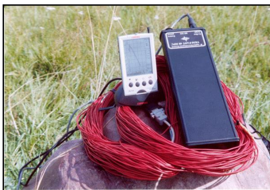
Figura 78 – Imagem do equipamento TEM-FAST 48, da AEMR.
