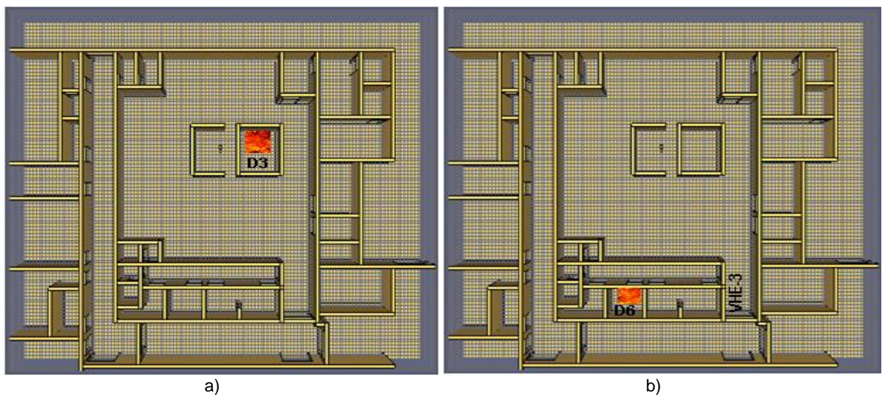
Figura 4.9. Localização dos focos de incêndios no CCF SU; a) sala aberta e b) arrumações.
