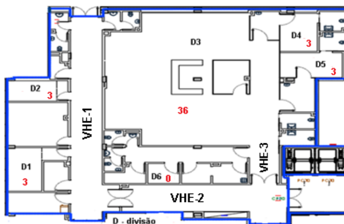
Figura 4.10. Nomenclatura das principais divisões e distribuição do efetivo pelas mesmas, para o CCF SU.
