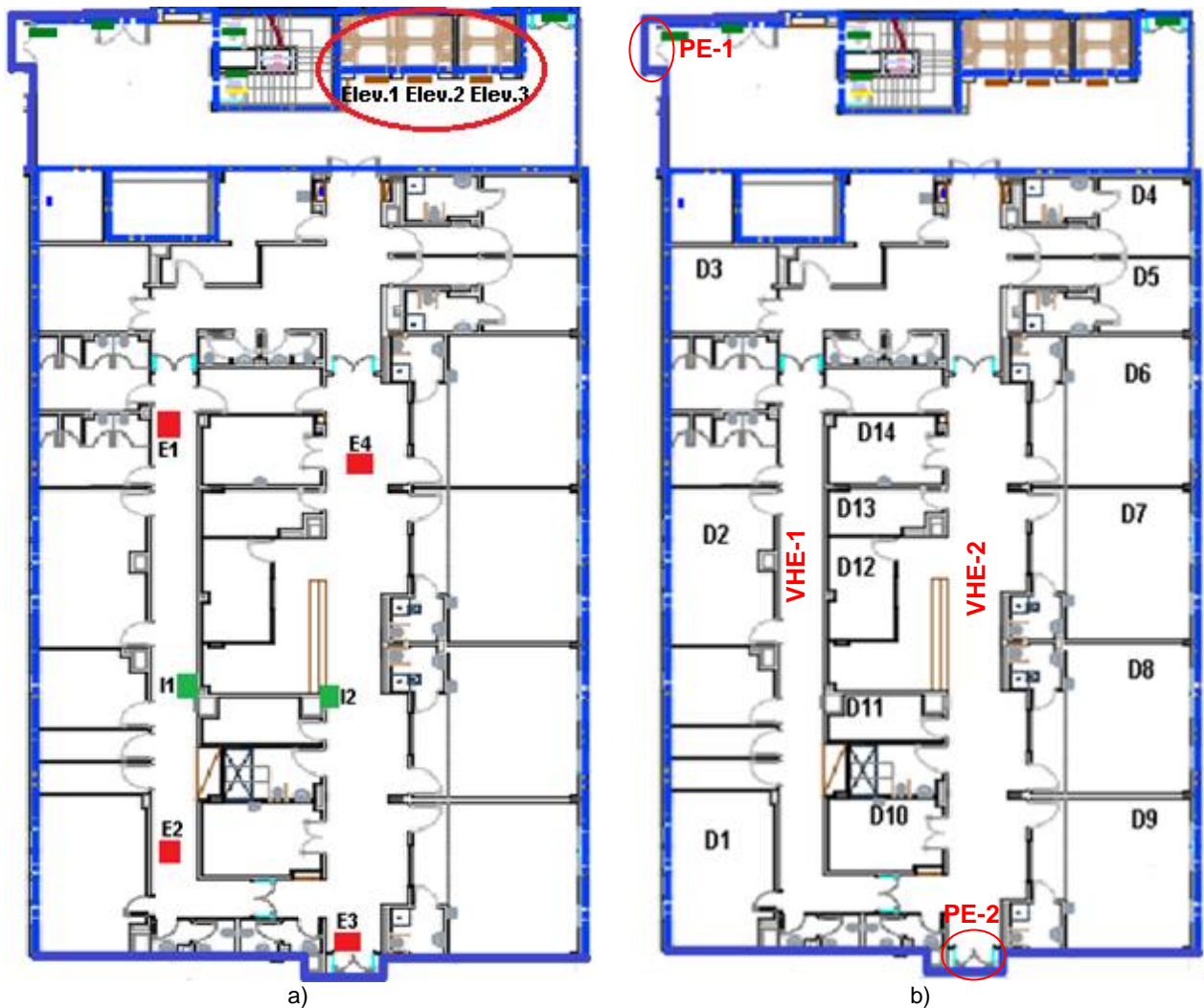
Figura 4.3. Compartimento corta-fogo SI; a) SCF e elevadores, b) portas das divisões e de evacuação, VHE e nomenclatura das principais divisões.
