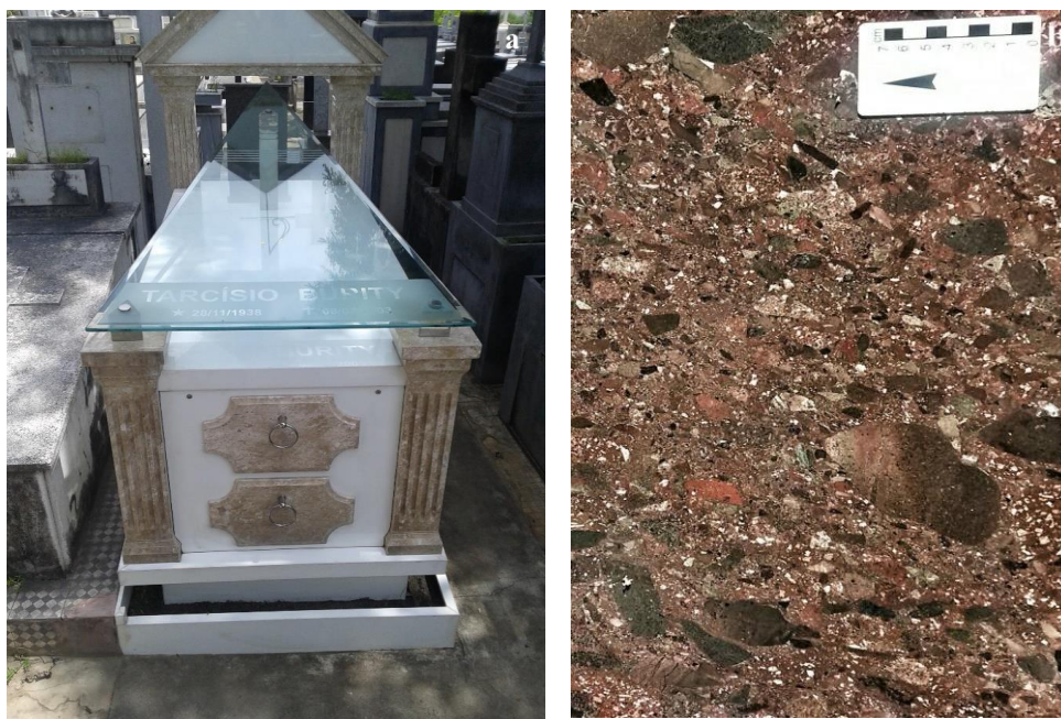
Foto 8.27 - Rochas sedimentares no cemitério. a) Túmulo do Governador Tarcísio Burity, mostrando o Marmoglass (branco) e as colunas de Travertino. Foto: o autor; b) Detalhe do conglomerado do túmulo de Odilon Ribeiro Coutinho. Foto: o autor.
