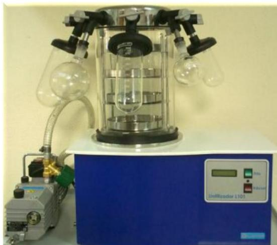
Figura 11 Imagem do liofilizador de bancada utilizado
