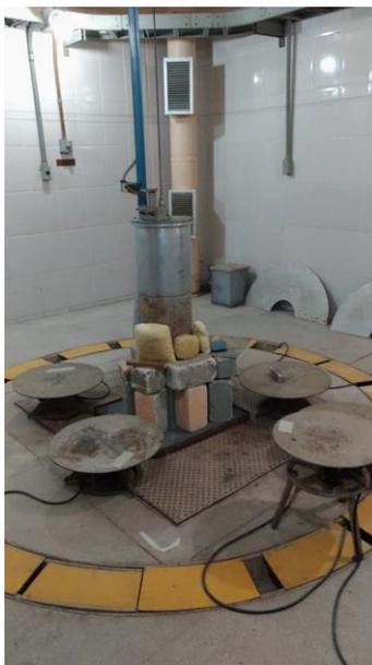
Figura 9 Fonte de Cobalto 60 do Laboratório de Irradiação Gama - LIG do CDTN.
