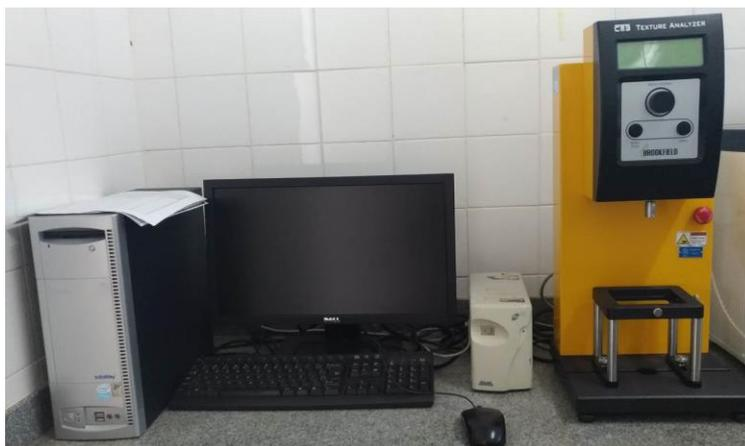
Figura 10 Imagem do texturômetro utilizado
