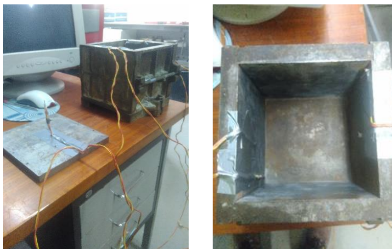
Figura 3.4 – Colocação dos termopares no provete e molde de controlo.
