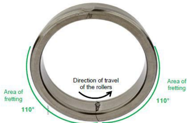
Fotografia 2 – Anel externo do rolamento danificado.
