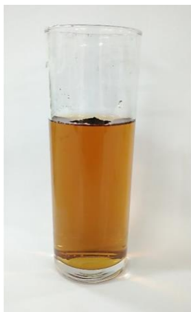
FIGURA 3.7 – MWCNTs na solução com surfactante LigniOx-LB antes da aplicação de ultrassons.
