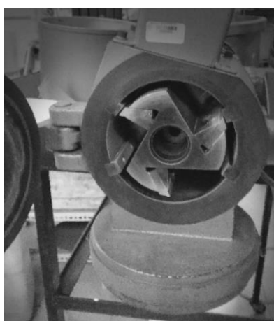
FIGURA 3.3 – Moinho de martelos utilizado na redução de tamanho das cascas de árvore de carvalho e pinheiro.
