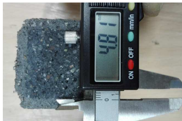
Figura 4.10 – Provete de Mapei Sewament 10: grau de corrosão na secção de corte.
