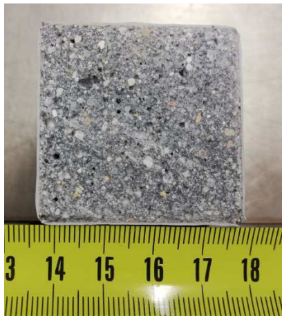
Figura 3.16 – Fotografia da secção de corte.
