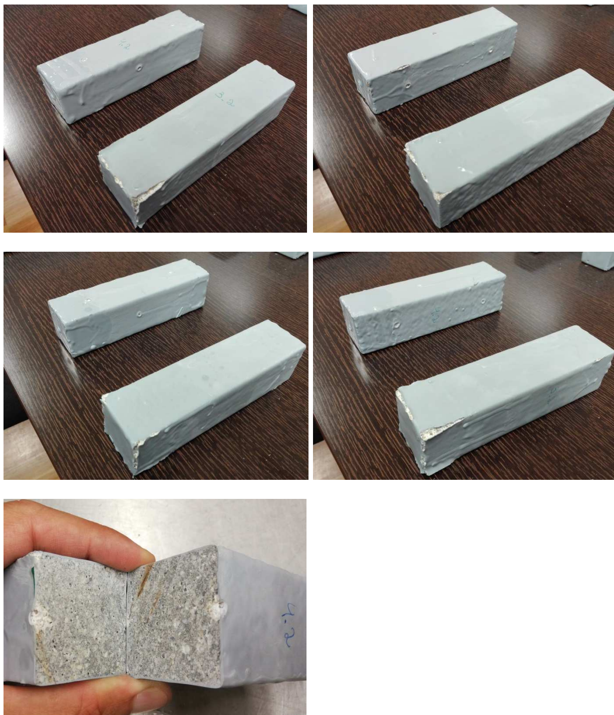
Figura 8.10 – Fotografias de provetes de argamassa de referência, revestidos com epóxi, COM introdução de defeitos na pintura (ref a 4.2) e SEM introdução de defeitos na pintura (ref a 3.2), após 14 dias de imersão em ácido.
