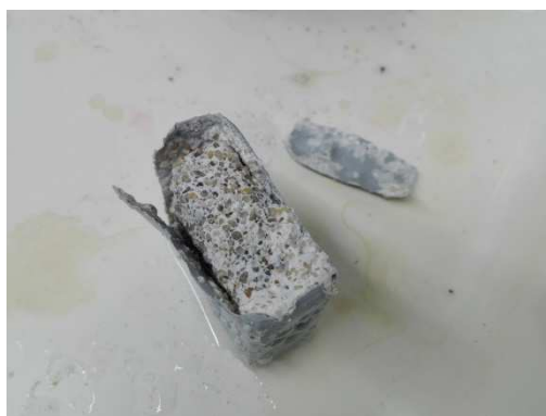
Figura 4.8 – Provetes de argamassa de referência revestida a epóxi, após ensaio de pH 0 por 14 dias.
