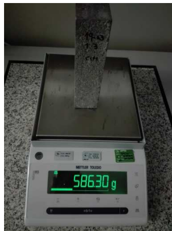
Figura 3.14 – Medição de massa realizada com balança digital Mettler Toledo.
