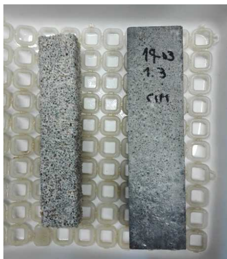
Figura 5.4 – Provetes de argamassa de referência após 21 dias de imersão em ácido pH 0; após 21 dias de imersão em água.
