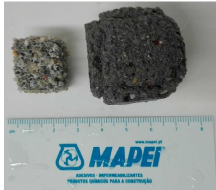
Figura 4.6 – Registo fotográfico de provetes após ensaio de imersão em 70 dias com pH 1: argamassa de referência; Sewament 10.
