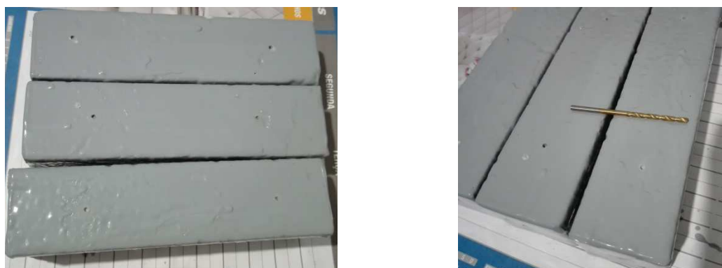
Figura 3.11 – Provetes com defeitos induzidos com berbequim equipado com broca de 2 mm.
