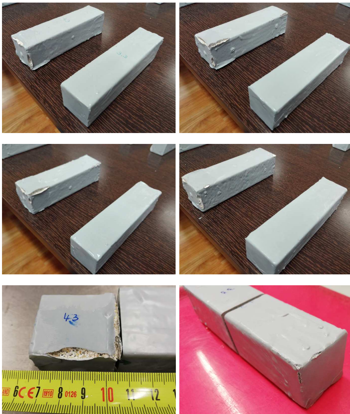
Figura 8.11 – Fotografias de provetes de argamassa de referência, revestidos com epóxi, COM introdução de defeitos na pintura (ref a 4.3) e SEM introdução de defeitos na pintura (ref a 3.3), após 21 dias de imersão em ácido.
