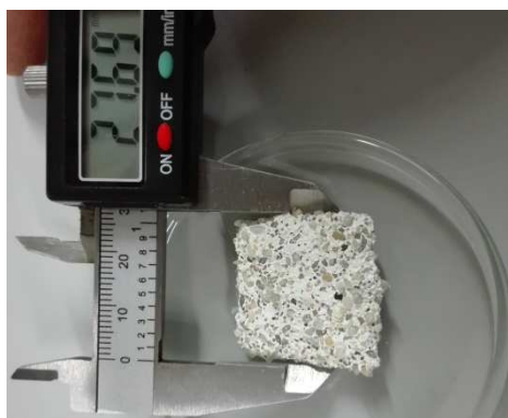
Figura 4.2 – Fotografia de provete Ref após ensaio de imersão em 14 dias com pH 0.
