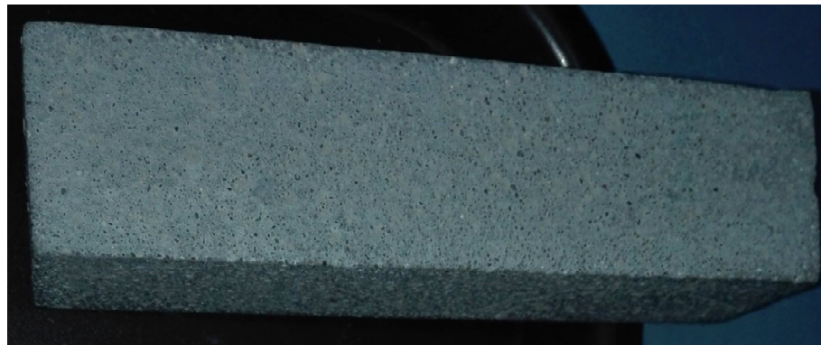
Figura 3.8 – Provetes após lixagem e colmatação da porosidade superficial.
