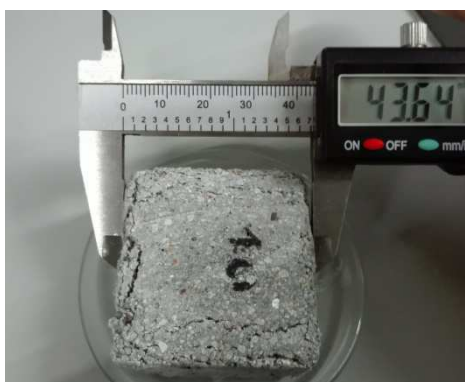
Figura 4.3 – Fotografia de provete SM10 após ensaio de imersão em 14 dias com pH 0.
