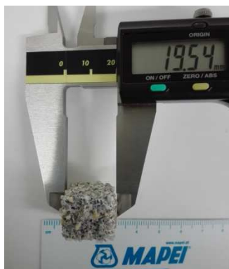
Figura 4.4 – Registo fotográfico de provete Ref após ensaio de imersão em 14 dias com pH 0.
