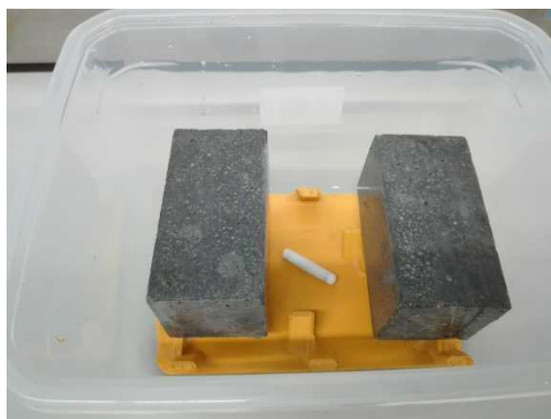
Figura 3.12 – Caixa em polipropileno com fundo em tela grampeada de polietileno de alta densidade.
