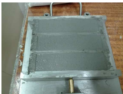
Figura 3.6 – Aspeto dos provetes após compactação.
