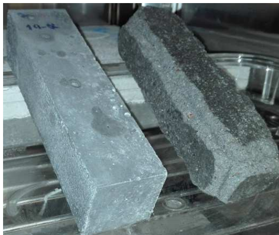
Figura 5.3 – Provetes de Mapei Sewament 10 após 21 dias de imersão em água; após 21 dias de imersão em ácido pH 0.
