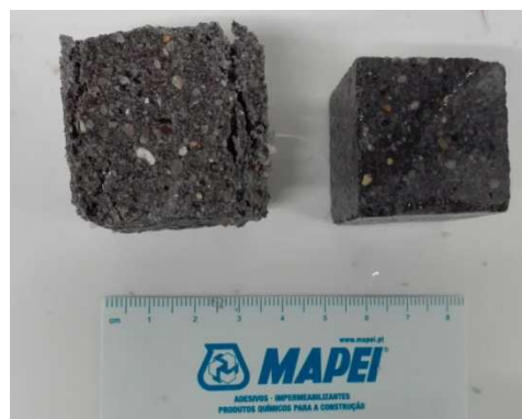
Figura 4.5 – Fotografia de provetes de SM10; após ensaio de imersão em 14 dias com pH 0; após imersão em água.
