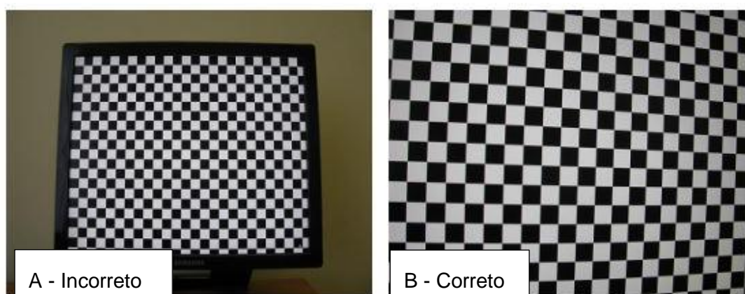
Figura 16 - A: Modo incorreto de realizar a calibração; B: Modo correto de realizar a calibração.
