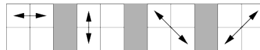
Figura 5.6: As quatro direções de vizinhança possíveis definidas no cálculo de descritores de Haralick [53].
