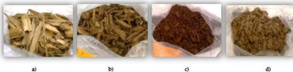
Figura 16 - Evolução do aspeto visual das aparas de cepos de pinheiro desde a a) matéria-prima original até à pasta obtida após b) a explosão de vapor, c) o processo organosolv , e d) o tratamento NaOH+AQ.
