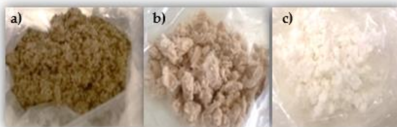
Figura 19 - Evolução da cor da pasta produzida a partir de aparas de cepos de pinheiro pré-tratada com explosão a vapor+ organosolv +NaOH/AQ: a) pasta 3 (CP-EW3N); b) 3-OO; c) 3-OOD 0 EpD 1 .
