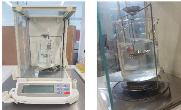
Figura 36 - Montagem para execução de medidas segundo o princípio de Arquimedes (CTCV)
