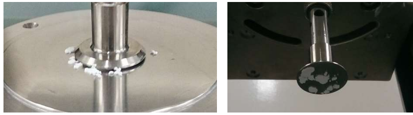
Figura 38 – Problema de desagregação da amostra de pasta durante a medição no reômetro
