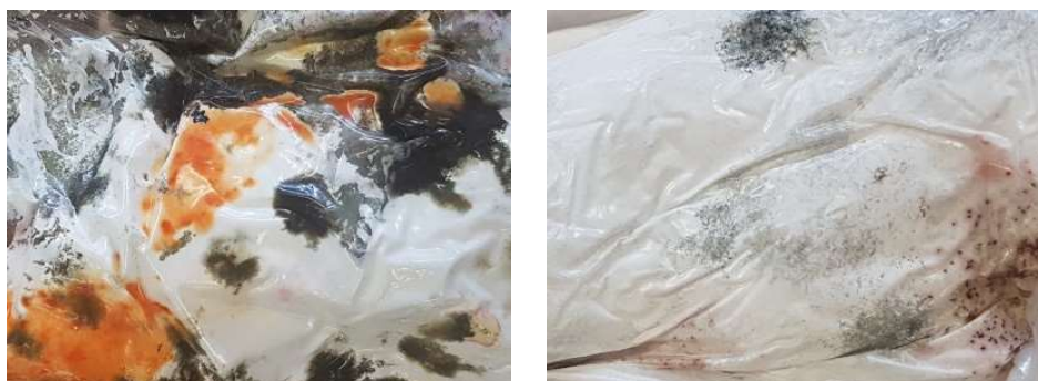
Figura 44 - Biodegradação das pastas do sistema Z após 10-15 dias
