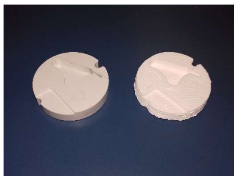
Figura 58 - Comparação entre peça produzida por moldação por injeção de cerâmicos com AD0,4 no CTCV (esquerda) e peça produzida por robocasting (direita)
