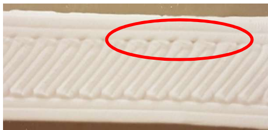
Figura 27 - Provete com vazios entre filamentos
