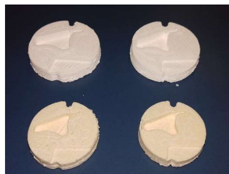
Figura 59 - Peças exemplificativas em verde (acima) e após sinterização (abaixo)
