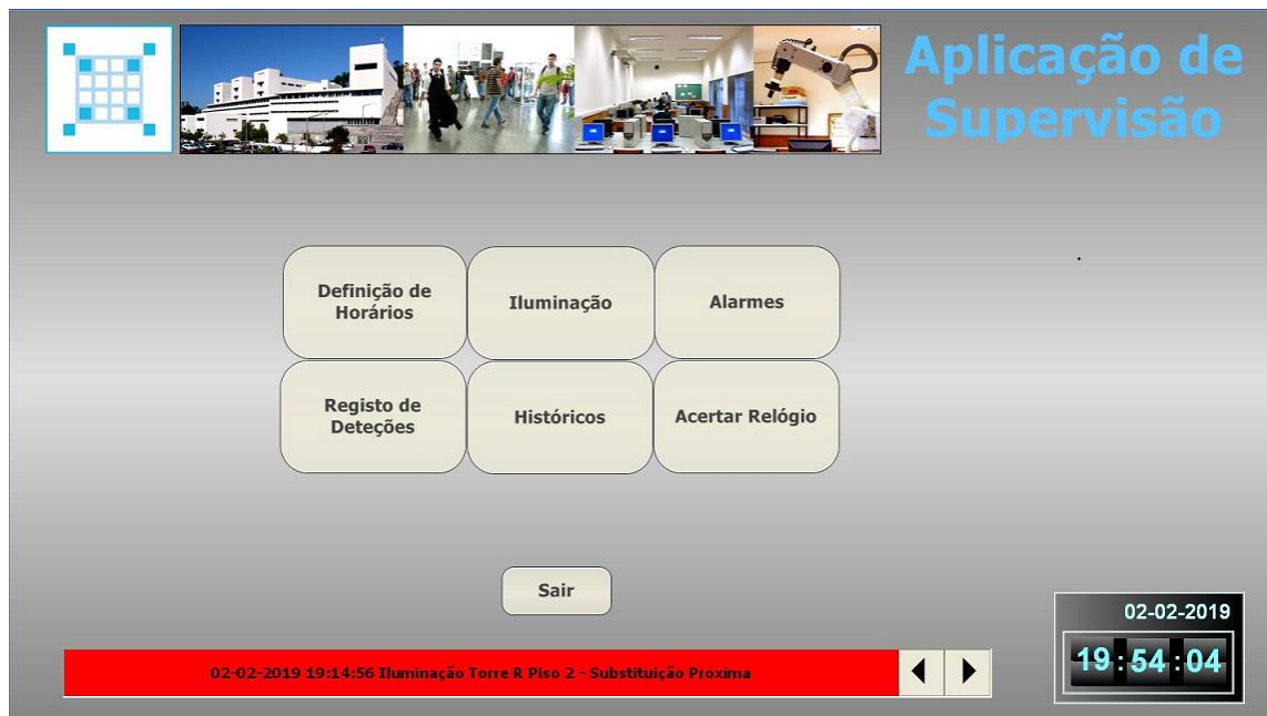
Figura 8 - Ecrã principal da aplicação de supervisão
