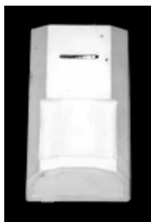
Figura 63 - Exemplo de um detetor de ocupação instalado no edifício
