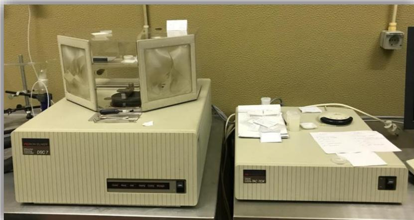
**Figura 2.6** Calorímetro diferencial de varrimento Perkin-Elmer DSC7
