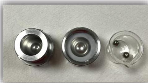
**Figura 2.3** Células de 10 mL e esferas de 7mm.
