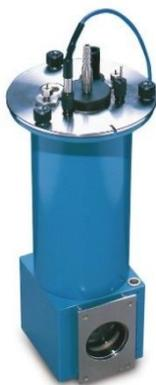
**Figura 2.5** Célula para VT-FTIR, com porta pastilhas
