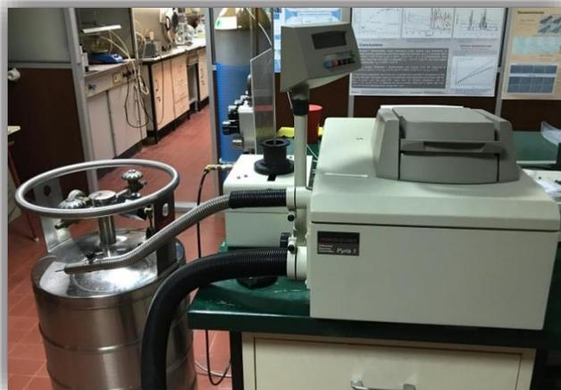
**Figura 2.7** Calorímetro diferencial de varrimento Perkin-Elmer modelo Pyris1
