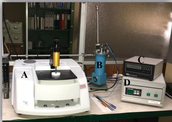
**Figura 2.4** A-Aparelho de FTIR-ATR; B- Célula para VT-FTIR; C- Leitor de pressão; D- Controlador de temperatura
