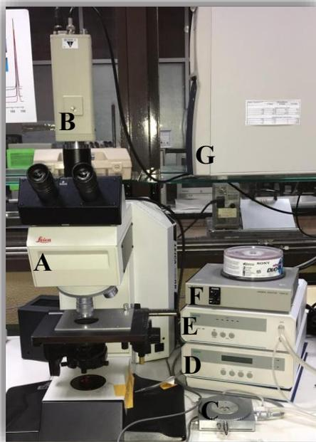
**Figura 2.9** Equipamento para as experiências de PLTM: **A-** Microscópio; **B-** Câmara de vídeo; **C-** Placa de aquecimento/arrefecimento; **D-** Interface de computador; **E-** Sistema de controle de refrigeração; **F-** Interface gráfica; **G-** Computador;
