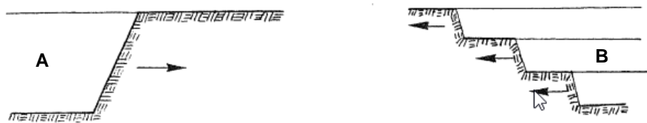
Figura 5: Corte de uma frente de desmonte num único degrau (A) ou em múltiplos degraus (B). Fonte: IGM, 1999b.
