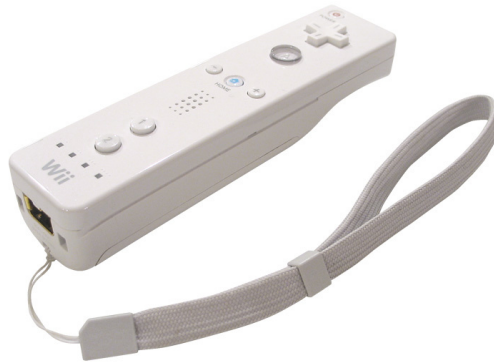
Figura 5.4: Comando Wii usado para controlo remoto do robô e para a realização de chamadas a serviços ROS.
