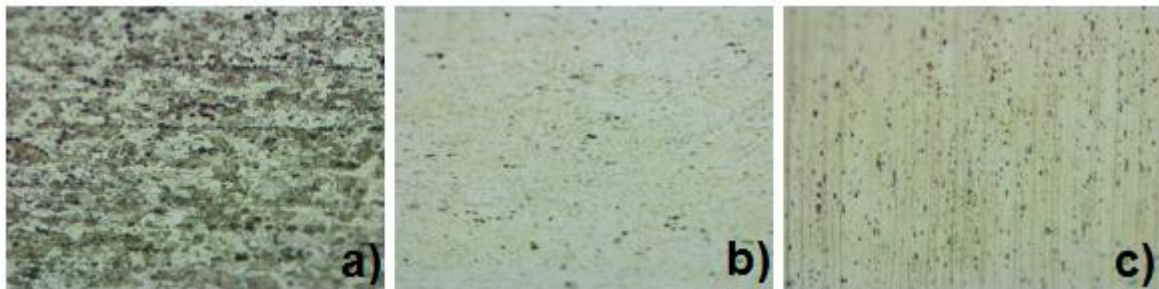
Figura 4.14. Material base das ligas: a) AA2017, b) liga AA5083, c) liga AA6082 (Ampliação 20X das imagens)
