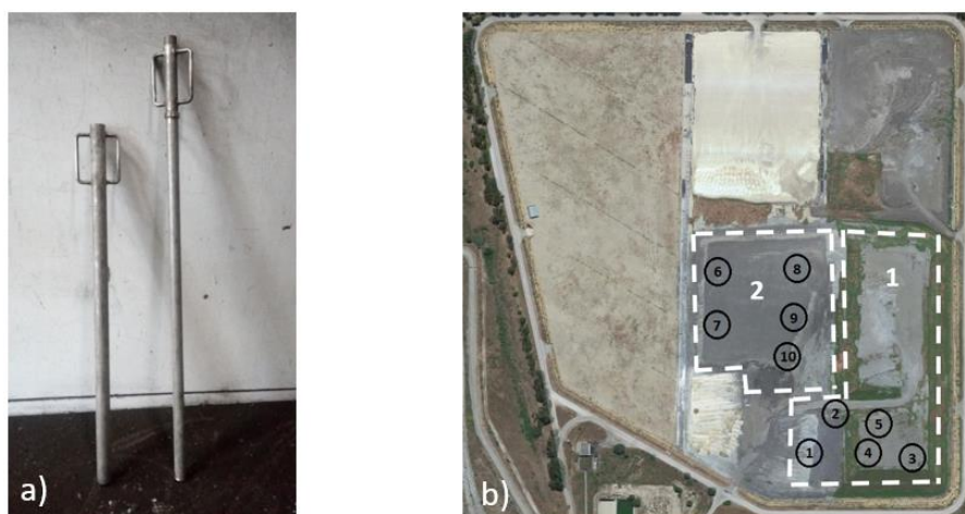
Figura 5.2 – a) Instrumentos de recolha de amostras de CV em profundidade; b) locais de amostragem na zona 1 do aterro (A1 – A5) e na zona 2 (A6 – A10).
