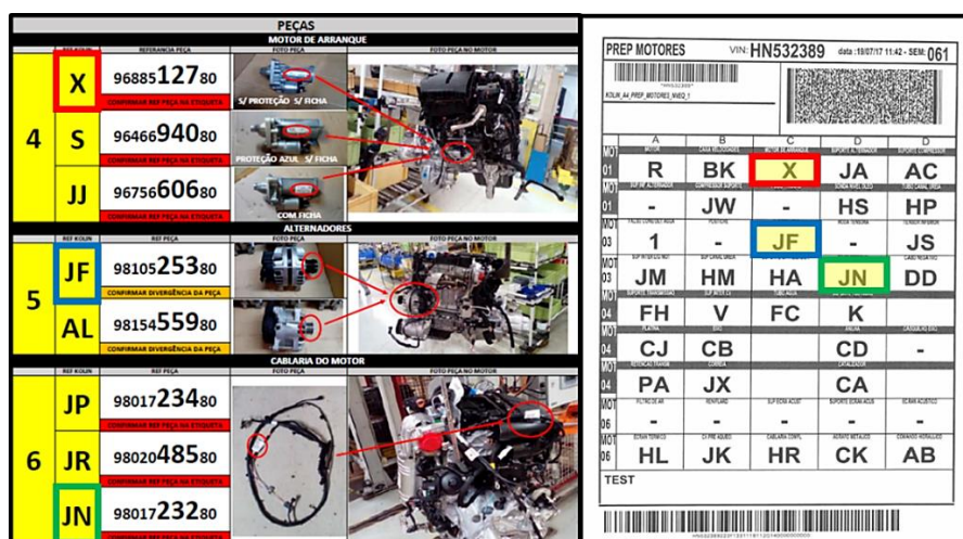
Figura 0.10. Exemplo do painel de controlo visual das peças Motor de Arranque e Cablaria do Motor e a folha FAV com a referência Kolin.
