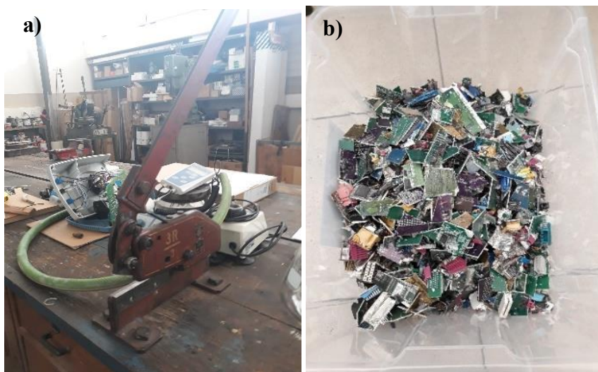
Figura 4.2 - a) Guilhotina e b) Material fragmentado.
