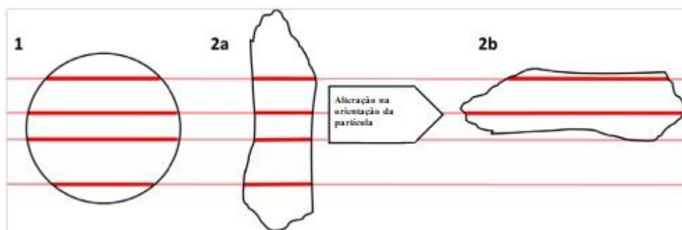
Figura 5. Exemplo do conceito de "corda" no FBRM na presença de partículas esféricas e irregulares (adaptado de Silva et al. (2013))
