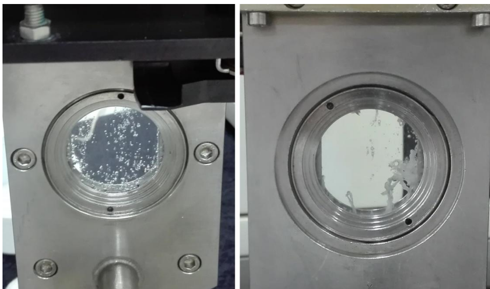
Figura 14. Acumulação de material na janela de medição do Mastersizer durante a monitorização online (imagem à esquerda) e durante a lavagem do equipamento (imagem à direita).
