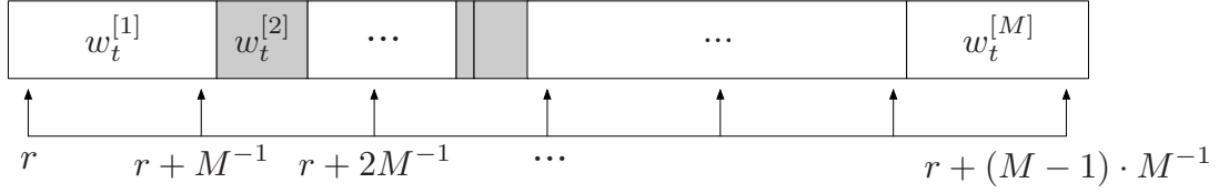
Figura 3.18: Princípio do procedimento de reamostragem pelo método Low Variance Sampling [61].
