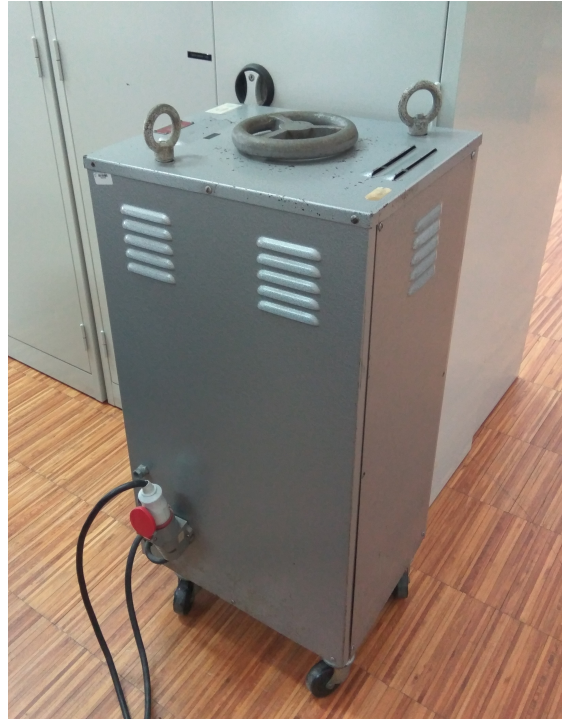
Figura B.1: Auto transformador, ligado à rede por via de disjuntores
