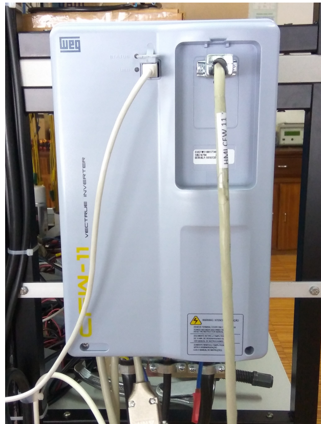
Figura B.5: Variador eletrônico de velocidade utilizado no controlo de velocidade da máquina de indução trifásica
