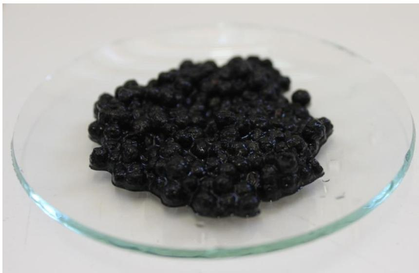
**Figura 4. 3 - Grânulos utilizados no reator EGSB.**
