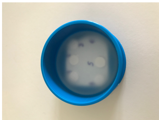
Figura 4.10: Aparência das pastilhas incorporadas na resina, num molde cilíndrico.
