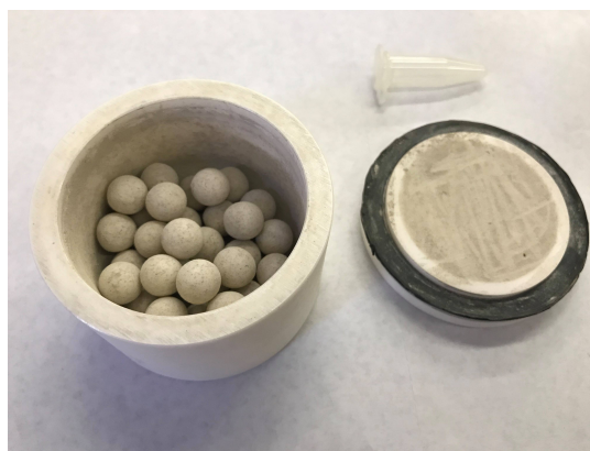
Figura 4.4: Taça e bolas de zircónia utilizadas nas sínteses por moagem a alta energia.
