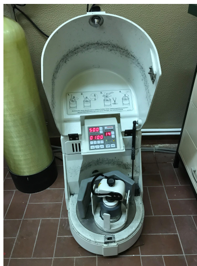
Figura 4.3: Moinho ( Fritsch-P6 ) utilizado para sintetizar os compósitos por moagem a alta energia.
