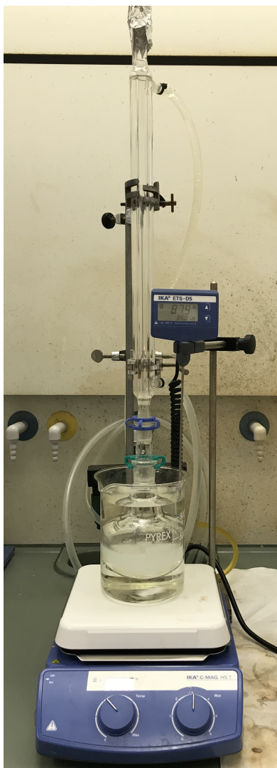
Figura 4.1: Montagem experimental utilizada para sintetizar os compósitos pelo método sol-gel.
