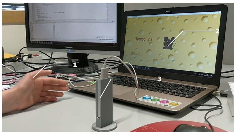
**Figura 4.9:** Fotografia retirada durante a execução do jogo. 1- Mão de um utilizador; 2- Interface gráfica; 3- LMC e respetivo suporte (descrito no apêndice B.3).
