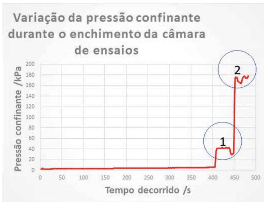
Figura 31: Gráfico da evolução de  $P_{Cell}$  durante o processo de enchimento da câmara
