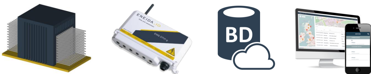
Figura 4.6 - O dispositivo em desenvolvimento estará conectado a uma gateway que poderá vir a ser um EWS-DTVI-g [60] revisto. Este, por sua vez, comunicará a informação recolhida a um servidor de base de dados e alertará direta e imediatamente a base de controlo, em caso de deteção de problema. A base de controlo terá ainda acesso aos dados por intermédio da base de dados.
