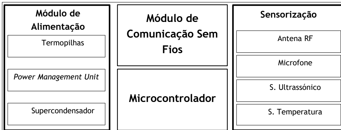
Figura 3.2 - Esquemática dos blocos funcionais do sistema, distribuídos em quatro blocos.
