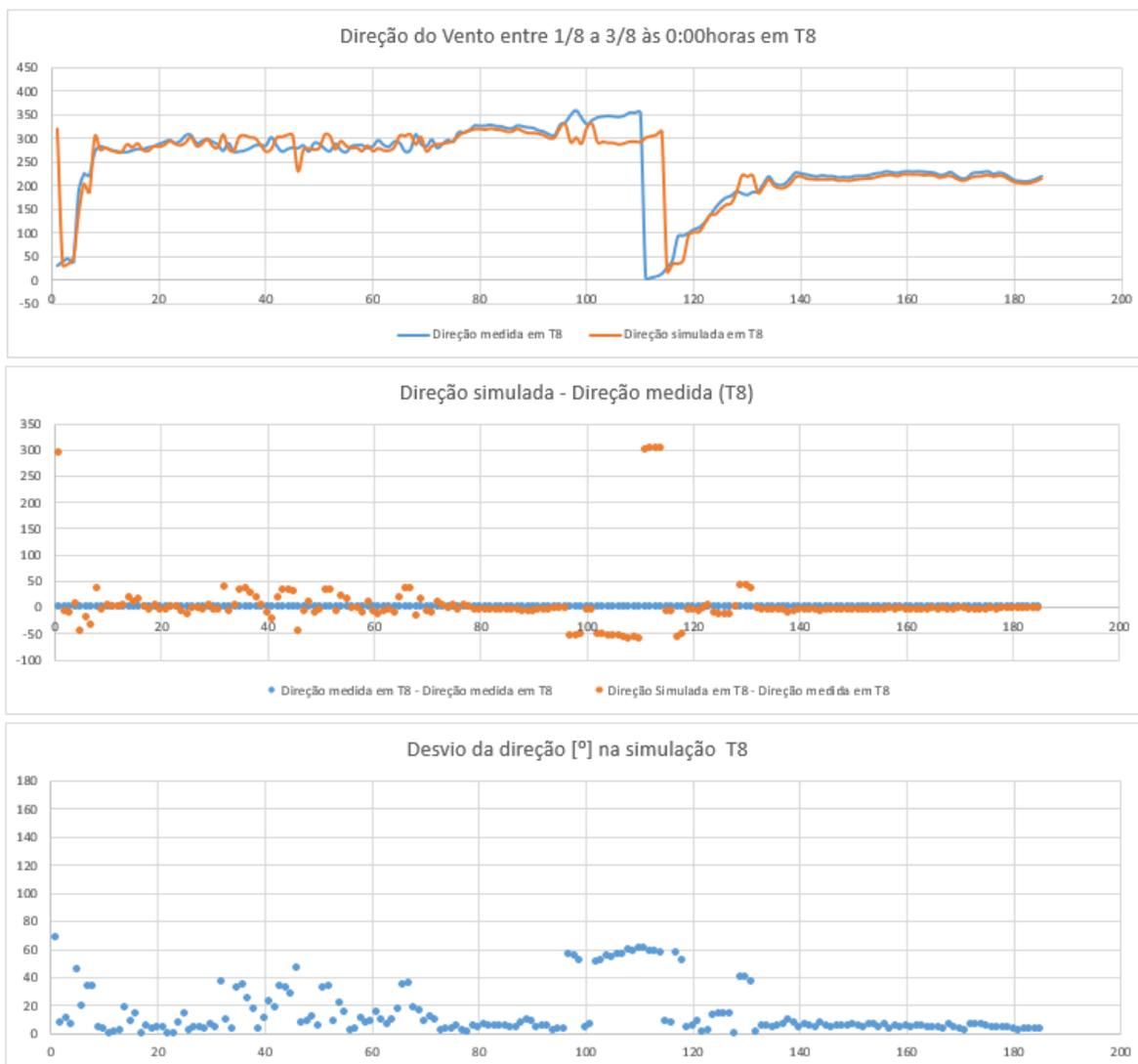
**Figura 29 - Comparação dos resultados obtidos por simulação computacional com os resultados obtidos experimentalmente, para o parâmetro Direção do Vento na turbina T8, entre os dias 1/8 e 3/8 de 2016 – Condições fronteira iniciais introduzidas na posição da turbina T20**
