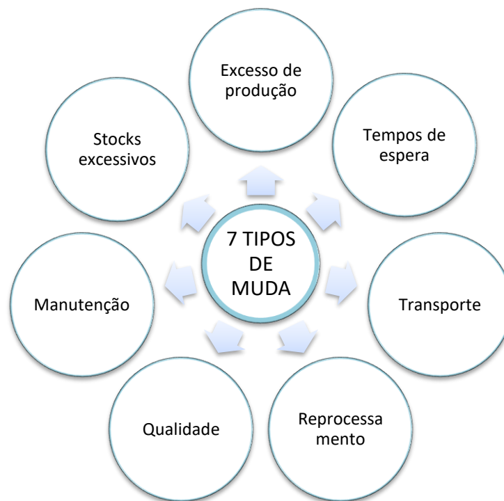
Figura 2.1. Identificação dos sete desperdícios (Adaptado de: Melton (2005))
