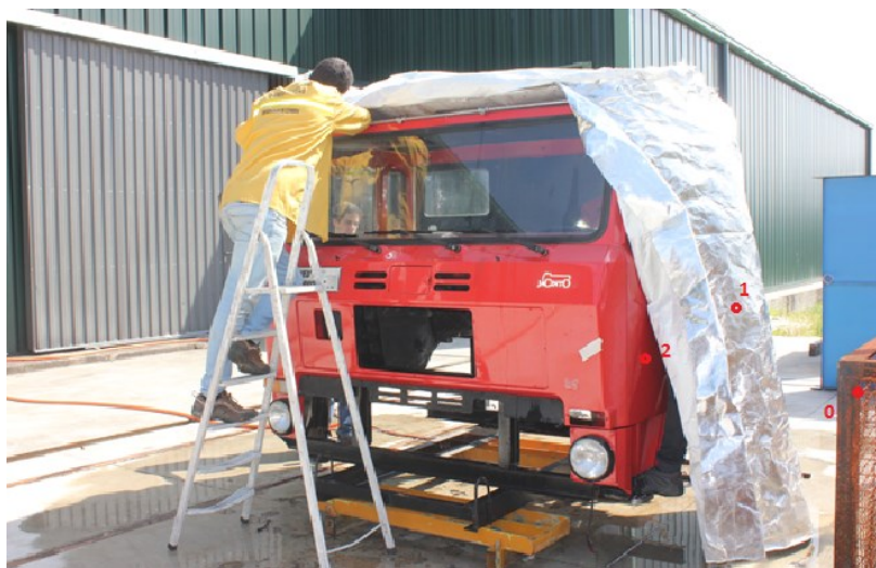
Figura 3.6 Termopares colocados no exterior da cabine (ADAI).
