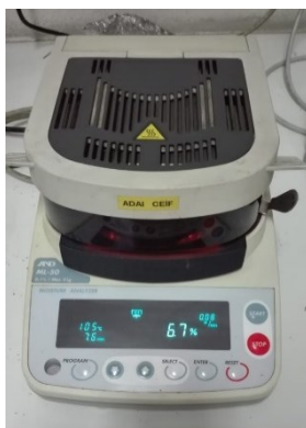
Figura 3.8 Medidor de humidade (ADA).
