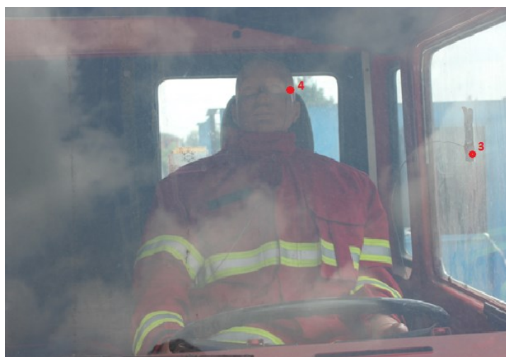
Figura 3.7 Termopares colocados no interior da cabine (ADAI).
