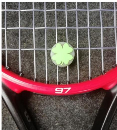
Figura 2.7 Anti-vibrador utilizado nos testes.
