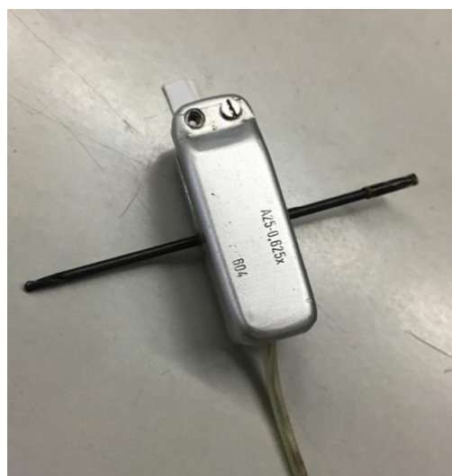
Figura 3.7 - Extensómetro utilizado para medição do fecho
