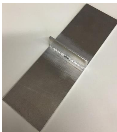
Figura 3.6 - Provete propagação de fissura
