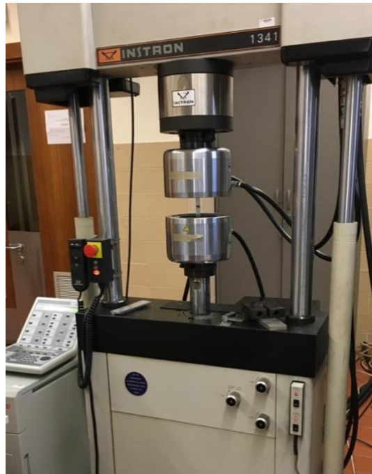
Figura 3.7 - Máquina INSTRON 1341 utilizada nos testes (fotografia retirada durante um ensaio)
