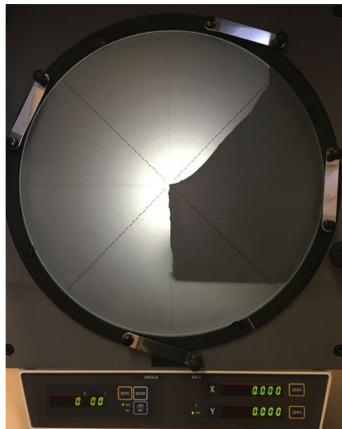
Figura 3.8 - Projetor de perfis mostrando um provete após a rotura por fadiga
