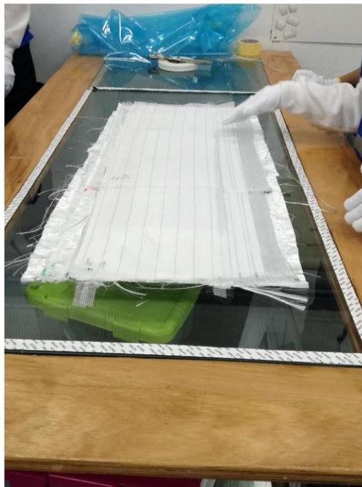
Figura 3 - Layup realizado em laboratório de testes
