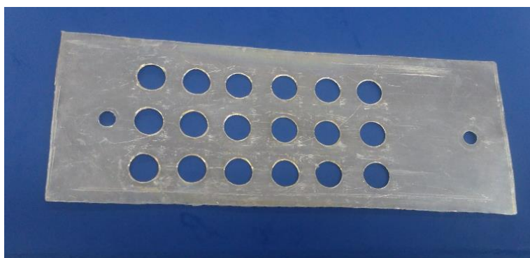
Figura 5. Máscara utilizada para deposição das lamelas e silício.
