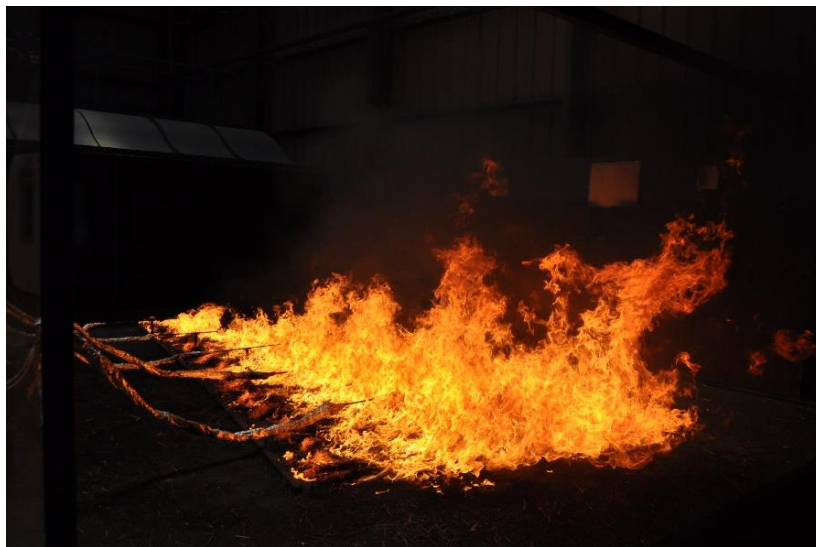
Figura 4.23 Fotografia do ensaio FC_E08 demonstrando fenómenos de vorticidade
