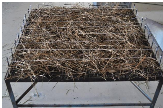
Figura 4.4 Fotografia da mesa para a realização do R_0 com a caruma distribuída e o fio
