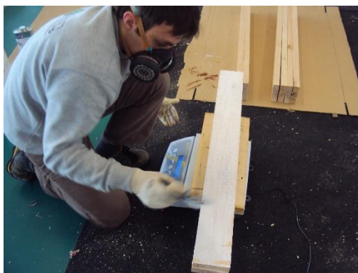
Figura 3.24 – Aplicação de cola manual através de espátula denteada – Cola EPI-1
