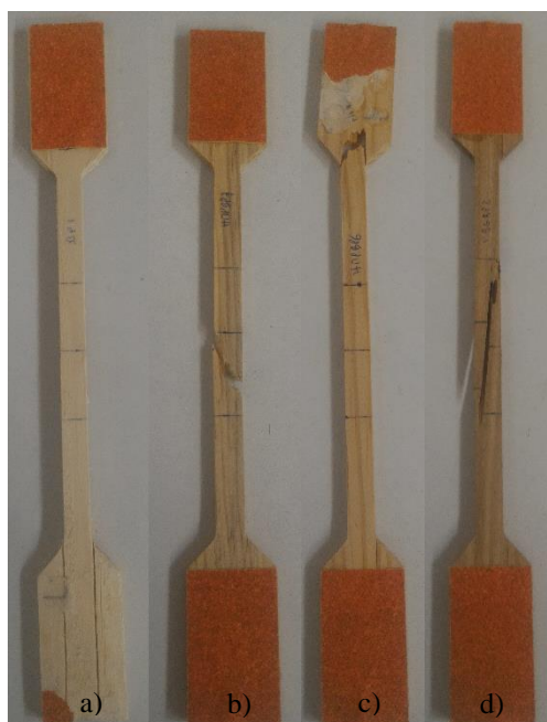
Figura 6.4 – Tipologias de rotura observadas nos ensaios de tração
