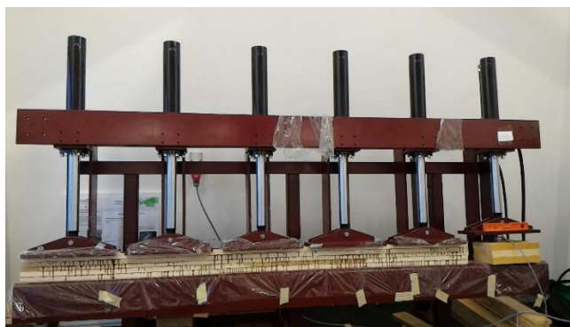
Figura 5.8 – Viga de Choupo sob o processo de pressão – cola PRF-1
