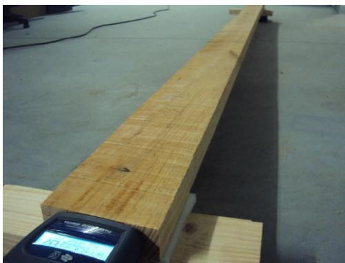
Figura 5.1 – Utilização do Timber Grader MTG na caracterização mecânica não destrutiva
