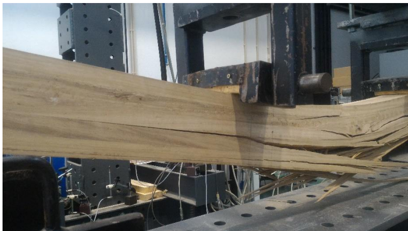
Figura 5.19 – Rotura da viga BG2 – propagação pontual da rotura ao longo da linha de cola 2
