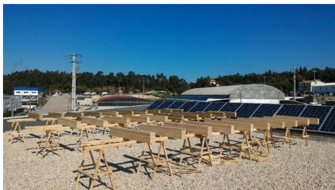
Figura 4.2 – Elementos de madeira lamelada colada em envelhecimento natural
