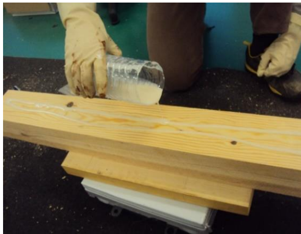
Figura 3.2 – Controlo da aplicação de cola na superfície das lamelas por pesagem – Cola EPI-1
