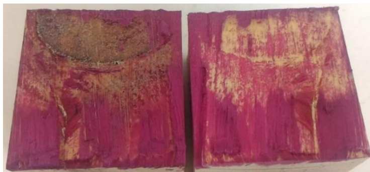
Figura 3.11 – Interface de linha de cola após ensaio de resistência ao corte para análise da WFP (cola branca – aplicação de mistura para evidenciar lenhina)
