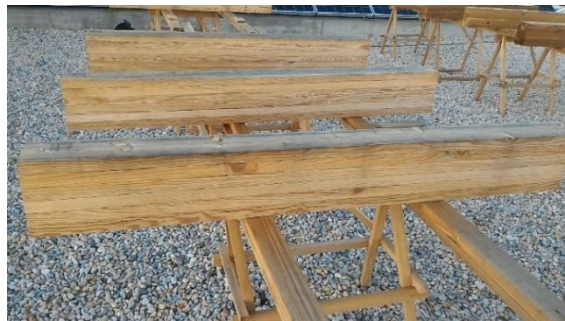
Figura 4.7 – Aparência de manchas acinzentadas na face sul dos elementos MP_{env} após 6 meses de envelhecimento
