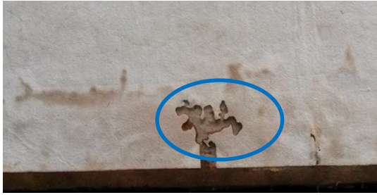
Figura 308: Galerias causadas por insetos na parte interior da encadernação
