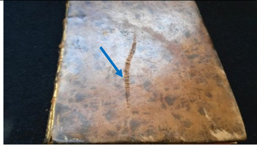
Figura 186: Arranhão na encadernação, possivelmente, causado por contato com objectos metálicos ou outros livros
