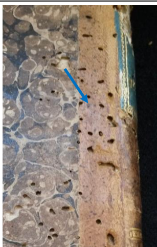
Figura 297: Orifícios causados por insetos
