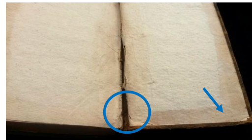
Figura 238: Desintegração da charneira e possíveis fungos, na extremidade inferior direita da página
