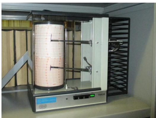
Figura 42: Termo-higrógrafo, usado antigamente na Biblioteca do DCV
