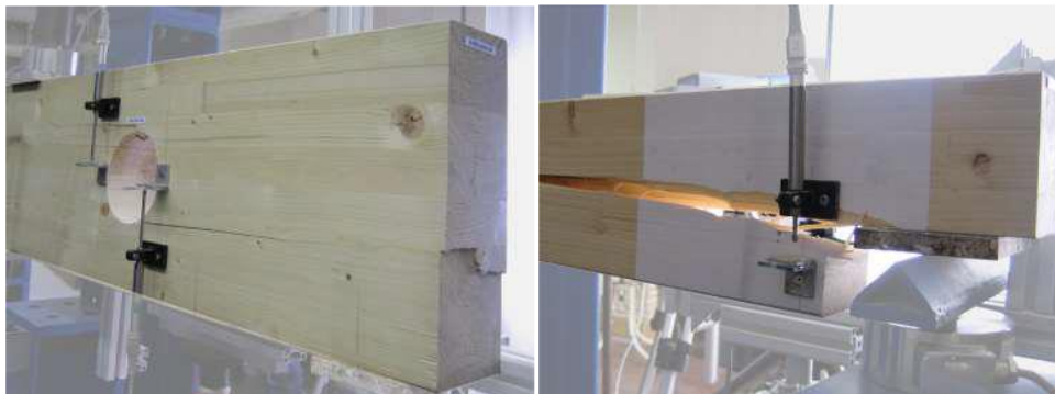
Figura 4. Rupturas por cisalhamento próximas a furos ou diminuições de seção Fonte: Franke et al. (2015)
