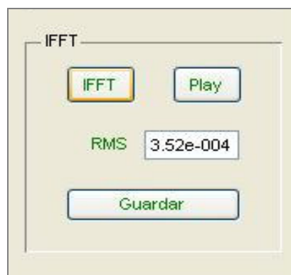
Figura 25 - Conversão do sinal para o espaço tempo utilizando o algoritmo IFFT. É também possível verificar se o sinal ficou calibrado segundo o valor de rms, é possível guardá-lo e ouvi-lo.
