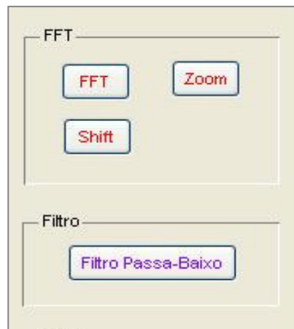
Figura 22 - Análise do sinal no espaço das frequências (aplicação do algoritmo FFT, ampliação e shift de frequências da zona do sinal seleccionada). É também possível a aplicação de um filtro passa-baixo com uma frequência de corte variável.
