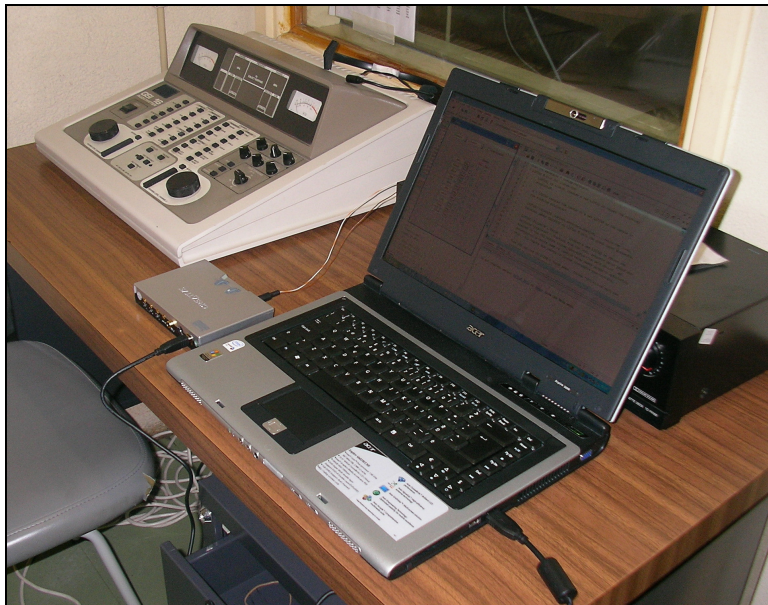
Figura 17 - Aparelhagem utilizada para a realização da audiometria vocal (sistema computador-placa de som-audiómetro).
