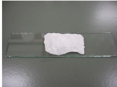
**Figura 28** – Revestimento de uma placa de vidro com poliestireno dissolvido em DMF.
