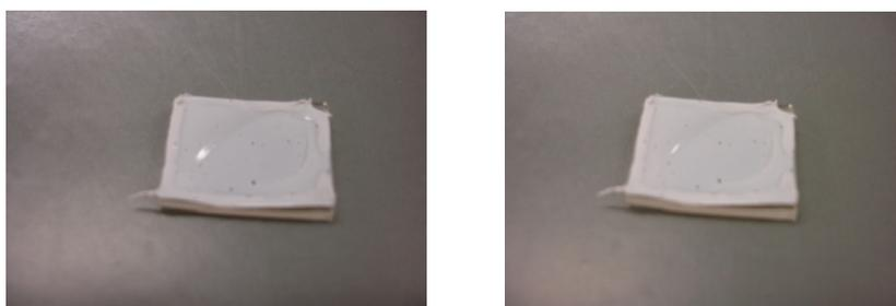
**Figura 21** – Elastollan 685A modificado com etilcelulose em diclorometano – metanol numa proporção de 1:1.
