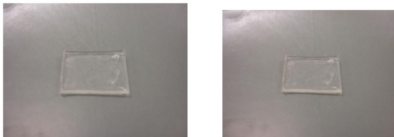
**Figura 25** – Elastollan 685A modificado com Elastollan 1180A50 em DMF.
