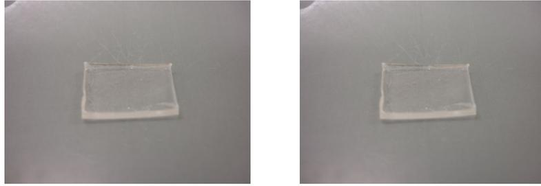
**Figura 26** – Elastollan 1180A50 revestido com poliestireno em tetrahydrofurano (THF).
