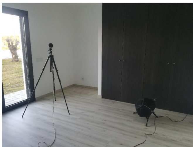
Figura 4.7 – Preparação para realização da medição do tempo de reverberação.
