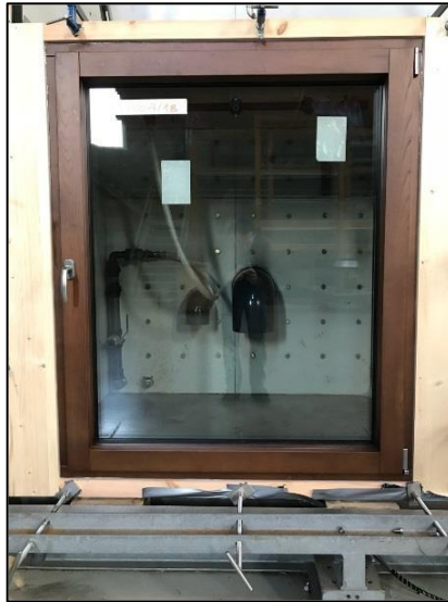
Figura 5.1 - Janela com Perfil E instalada em câmara de caixilhos.
