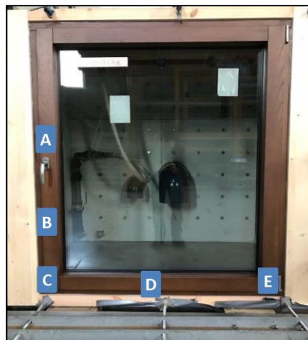
Figura 5.5 - Localização dos pontos de medição de deformações relativas ao ensaio de resistência ao vento.
