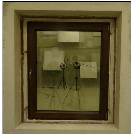
Figura 5.6 - Janela com Perfil E instalada em câmara acústica.
