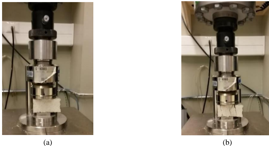
Figura 4.9 – Ensaio de resistência á compressão (a) provete prismático (40×40×80 mm) no estado inicial (b) provete prismático (40×40×80 mm) após a aplicação de uma força de compressão
