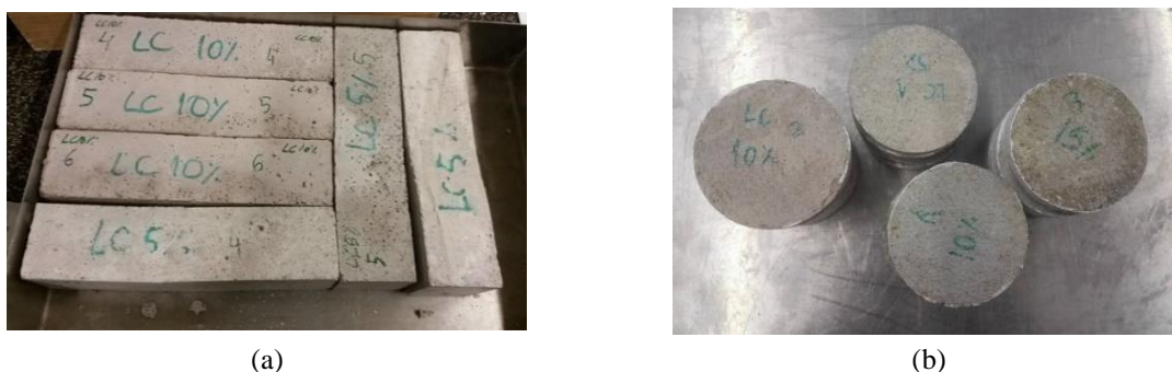
Figura 4.5 - Provetes no estado endurecido (a) provetes prismáticos (b) provetes circulares
