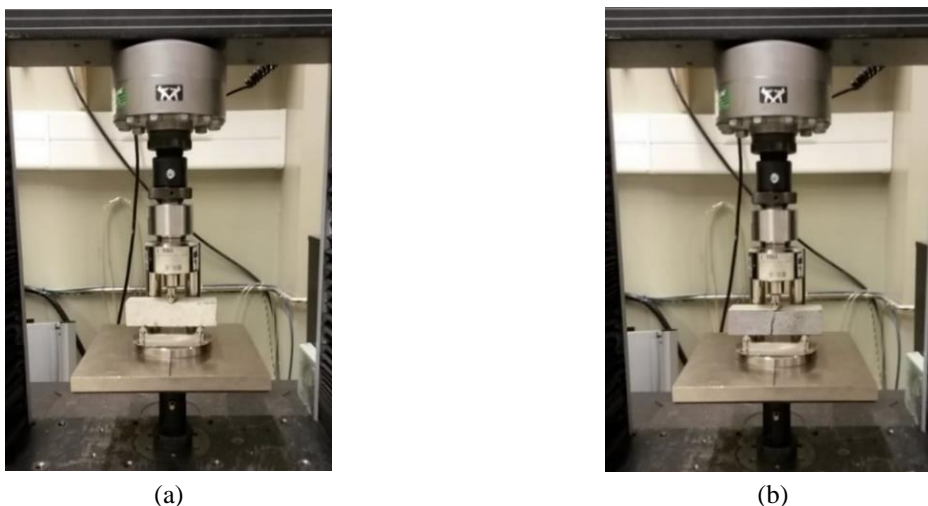
Figura 4.7 - Ensaio de resistência mecânica á tração por flexão (a) provete prismático (40×40×160 mm) no estado inicial (b) provete prismático (40×40×160 mm) submetido a rotura
